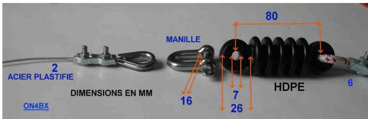
Les câbles d'antenne sont en acier plastifié. L'isolateur du bout est en polyéthylène haute densité. Les accessoires sont classiques et se trouvent aisément dans les grandes surfaces. Le câble et les isolateurs proviennent d'une firme anglaise qui est présente dans la quasi-totalité des foires radio-amateurs. Elle est présente chaque année à la foire réputée de La Louvière (ON6LL).
