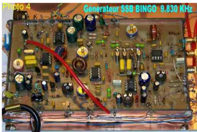
La description du Générateur BINGO SSB, qu'il soit avec une F.I. de 9.830 ou 10.240 KHz, est considérée comme équivalente, vu le peu d'écart de fréquence entre les 2 valeurs de F.I.
