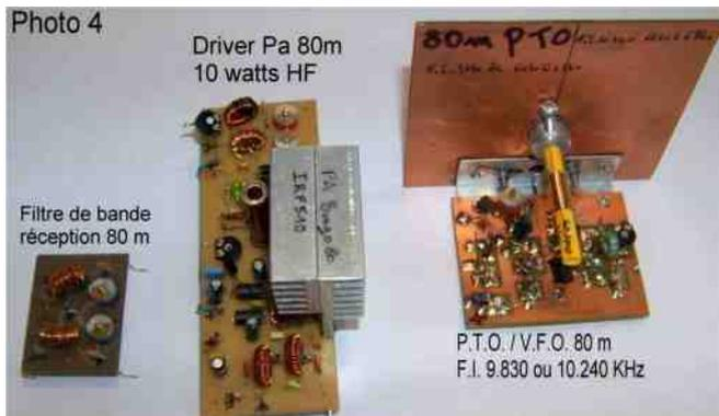
(Photo 4) : Voici les 3 éléments constitutifs des nouveaux BINGO UNO SSB et DUO SSB CW 80 m.
