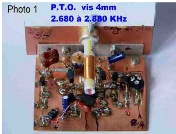
Cornière pour fixer platine et façade
