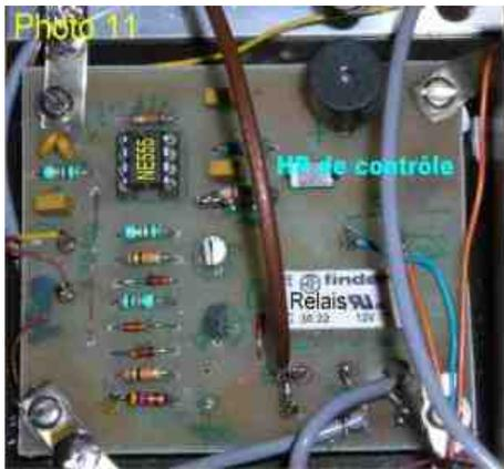
Nous avons regroupé sur une seule platine tous les éléments nécessaires à faciliter la construction du Bingo CW 17 m et à bien trafiquer. D'une part nous avons le passage automatique en émission dès le premier coup de manipulateur et d'autre part la génération de la tonalité de CW. Ce système très convivial assure un trafic rapide et efficace en CW QRP.
