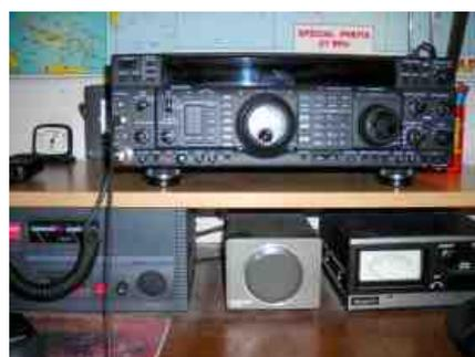
Je suis maintenant équipé d'un YAESU FT-1000MP et d'une beam 3 éléments de fabrication O.M., ce qui est bien plus agréable pour le confort d'écoute avec le manque de propagation.
