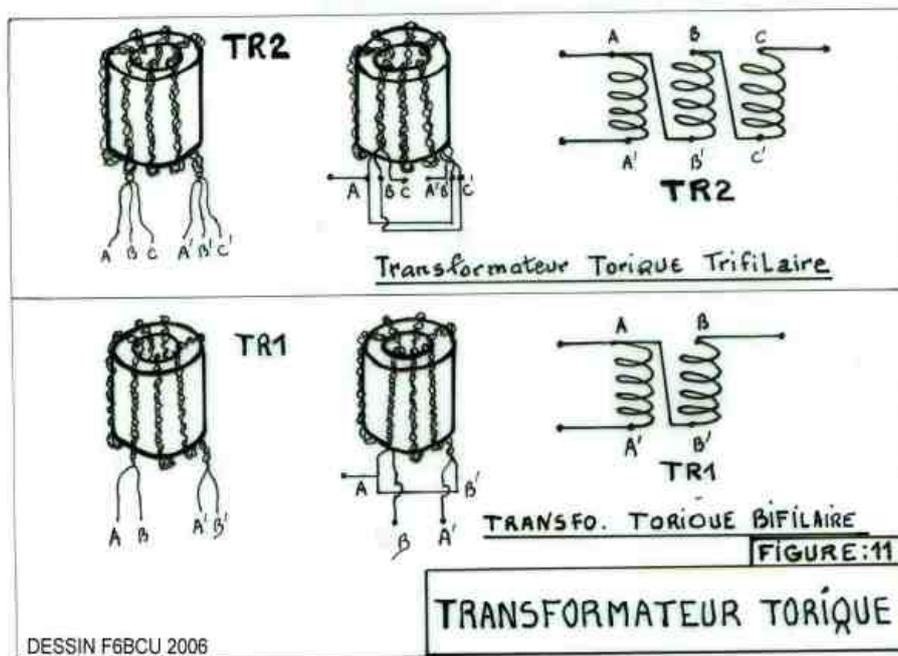
Photographies du détail de la confection du transformateur trifilaire. La partie marquée en l'air est repliée légèrement sans aucune incidence sur le fonctionnement et la puissance de sortie
