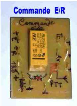
Ce système de commande de l'émission – réception par relais 2RT 12V est spécifique et identique à tous les Transceivers BINGO SSB de la \*Série DEOMECAO – BINGO\*.
