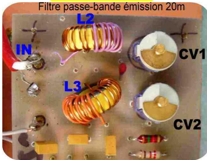
L'étage amplificateur Driver se compose d'un double filtre de bande ( L2, L3) accordé sur 20 m et d'un amplificateur large bande composé de 2 transistors en cascade : un 2N2222 et un 2N2219.
