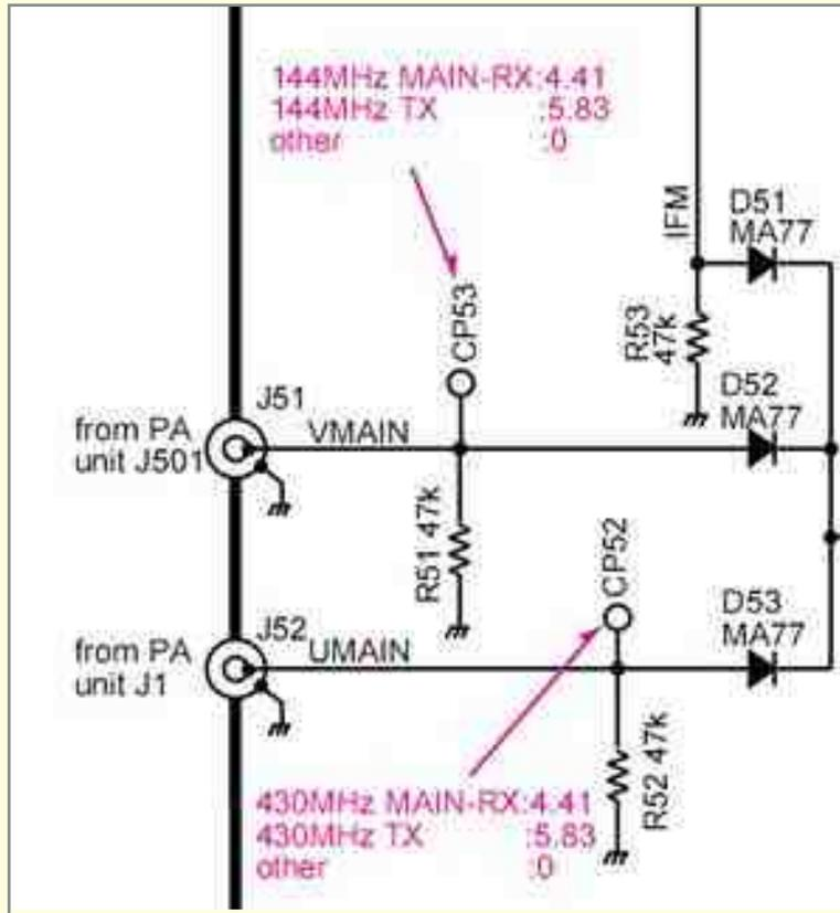
Ces deux connecteurs nous fournissent les tensions nécessaires pour détection de la bande active. Nous aurons la table de vérité suivante :
