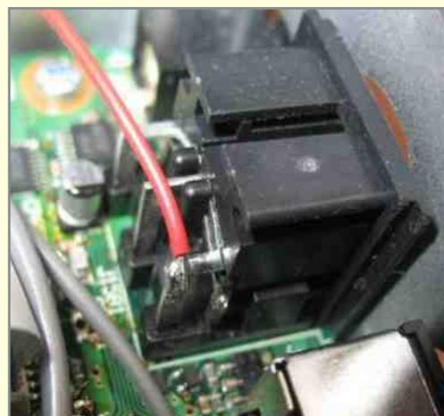
Pour terminer, il nous reste à trouver un moyen pour "sortir les signaux de la boîte". J'ai opté pour une prise SUB-D. En examinant l'arrière du transceiver, il se trouve une petite plaque qui correspond parfaitement aux dimensions d'une SUB-D 9 contacts. Après inspection, cette plaque se trouve au niveau du circuit PLL.
