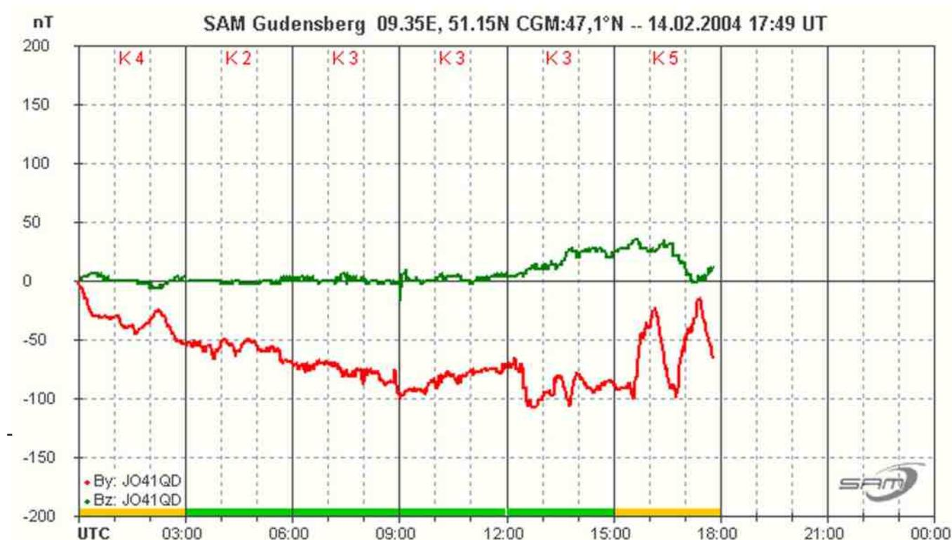
Pour pouvoir éventuellement détecter une aurore il faut d'abord étalonner le magnétomètre, le connecter à un système d'acquisition (PC) et effectuer un petit traitement du signal. Au paravent il faut déterminer 2 coefficients nommés K et A. Pour le coefficient K il suffit de mesurer la valeur crête à crête de la variation du champ magnétique sur une durée de 3 heures et de lire la correspondance dans le tableau ci-dessous suivante pour obtenir la valeur de K.
