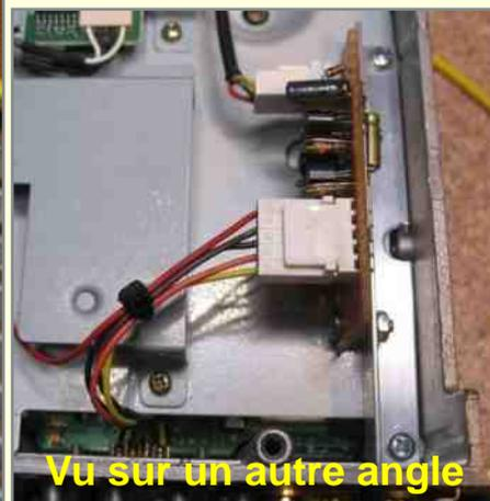
Le circuit imprimé est maintenu par une petite équerre en alu, elle-même tenue par 2 vis fixant le couvercle du module PLL.
