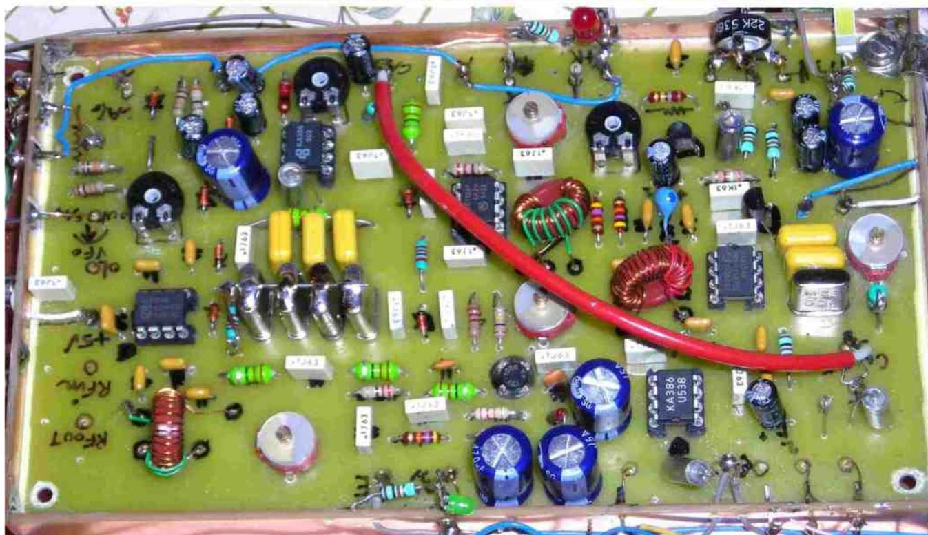
La fréquence intermédiaire ( F.I.) du filtre à quartz de fabrication Home-made était de 10.240 KHz ou 10,240 MHz. L'approvisionnement en quartz 10.240 KHz pose actuellement quelques problèmes.
