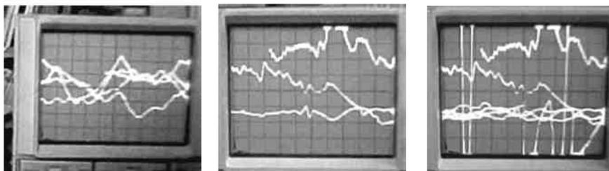
L'échelle horizontale du temps est de 2,5s/carreau alors que l'échelle verticale est de 0,5V/carreau, le système n'étant pas encore étalonné. On peut observer sur ces différents écrans des périodes de calme apparent, des périodes rapides mais de faibles amplitudes et des périodes très mouvementées et de grandes amplitudes. Au moment où j'écrivais ces lignes, il se produisit une petite tempête magnétique dont voici les derniers relevés.
