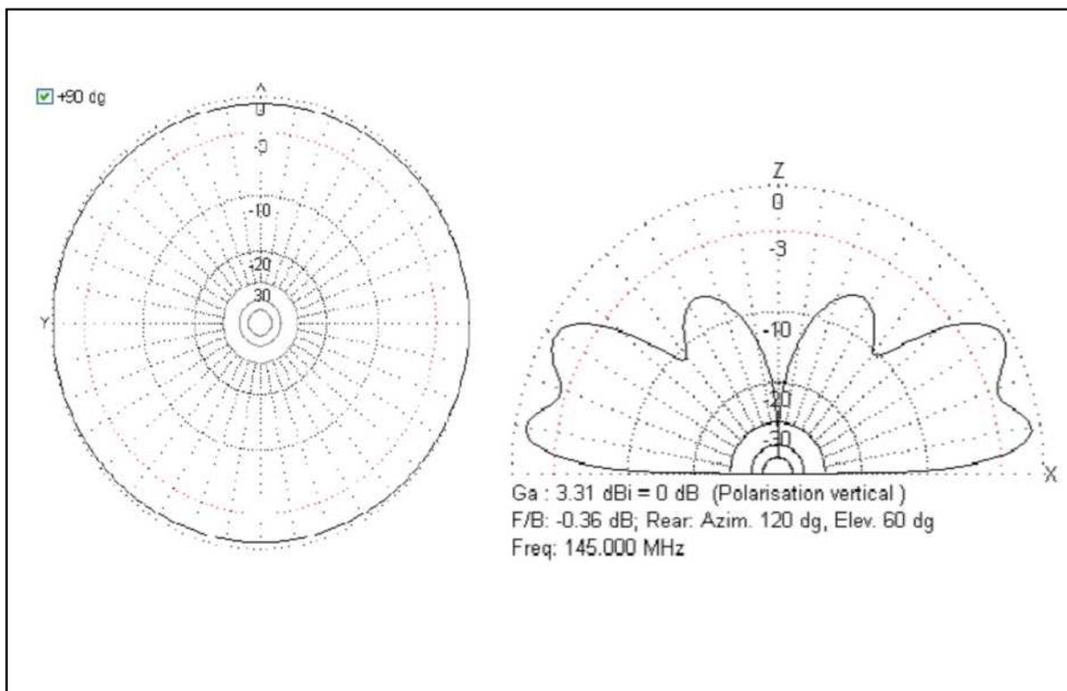
L'image de gauche ci-dessus montre le rayonnement théorique quasi omnidirectionnel de l'antenne vue de dessus. L'image de droite ci-dessus montre le diagramme de rayonnement dans le plan vertical de l'antenne. On pourra noter un gain théorique de 3,3dBi soit environ +1dBd. Ce gain ainsi que la forme des lobes seront très dépendant de la hauteur de l'antenne par rapport au sol et de son environnement.
