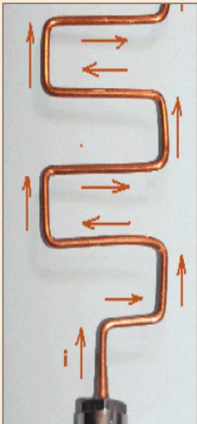
En première approximation je suppose que la répartition du courant se fait comme pour un aérien classique avec ventre de courant à la base et ventre de tension au sommet. On peut s'apercevoir sur l'image ci-contre que les segments de courant verticaux sont de même sens et s'ajoutent alors que les segments de courant horizontaux sont de sens opposé et s'annulent presque car ils n'ont pas tout à fait la même amplitude.
