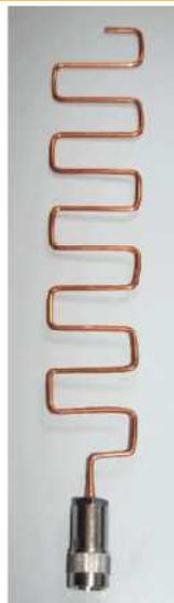
résistance mécanique de l'aérien ainsi que l'étanchéité. La capacité parasite constituée par le corps de la fiche et l'antenne à un effet non négligeable sur l'impédance à la base de l'antenne. Ses éléments verticaux mesurent environ 2 cms, les éléments horizontaux mesurent environ 4 cms et la longueur déployée est d'environ 68 cms (résonnance à 110 MHz) donc bien plus grande qu'un  $\frac{1}{4}$  d'onde.
