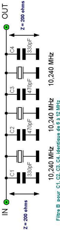
Cela signifie que le filtre à quartz est toujours adapté de 6 à 12 MHz en fonction de la bande CW.
