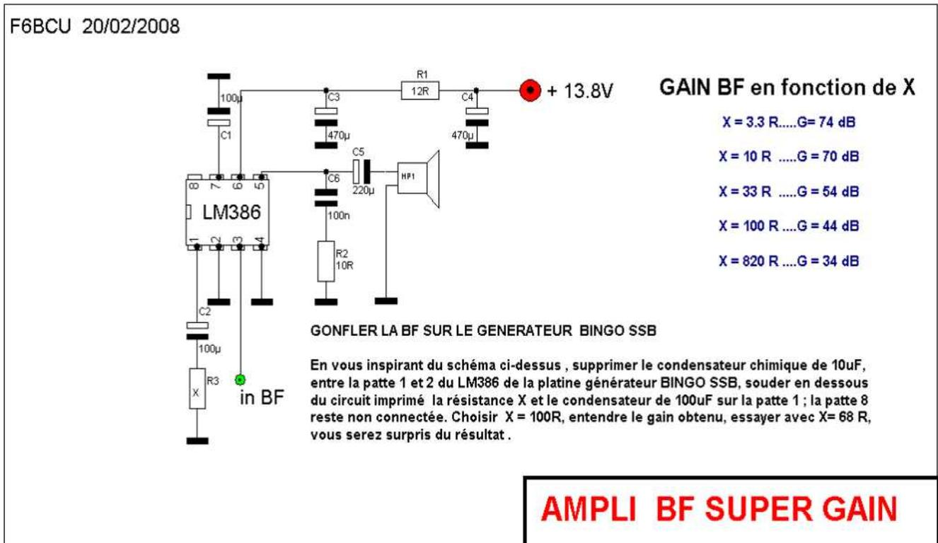
Sur le Générateur BINGO CW (schéma figure 1), la résistance X fait 27 . Si le souffle généré dans le Ht parleur du LM386 est trop important prendre la valeur de 68 qui est un excellent compromis dans le rapport souffle /puissance.
