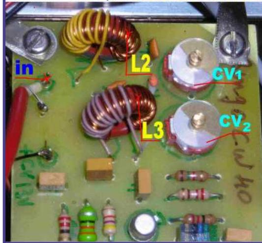
L'étage amplificateur Driver se compose d'un double filtre de bande (L2, L3) accordé sur 40 m et d'un amplificateur large bande composé de 2 transistors en cascade : un 2N2222 et un 2N2219.
