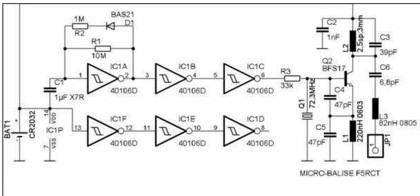
La mise au point est très simple. Alimenté sous 3 V le générateur d'impulsion doit fonctionner aussitôt (brancher la sonde de l'oscilloscope sur la broche 6 de IC1).
