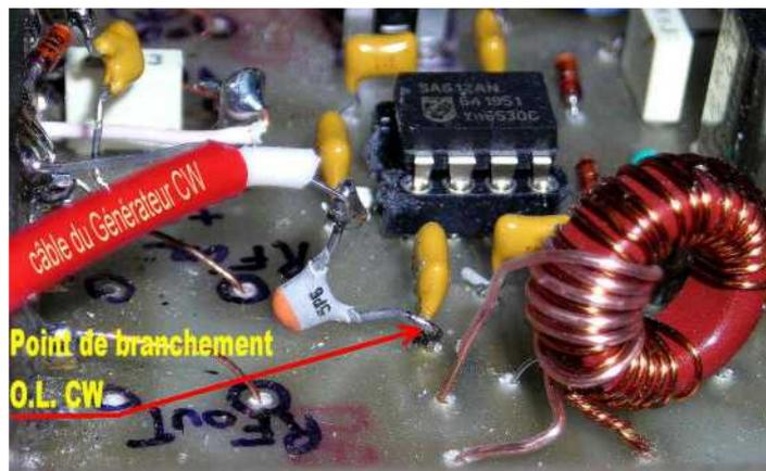
Détail de la liaison Générateur CW à Générateur SSB et détail de la connexion au niveau Pin 1 du NE612 N°2. L'extrémité de la capacité de 5,6pF est soudée juste sur la capacité de 1nF (1000pF) raccordée à la Pin 1.
