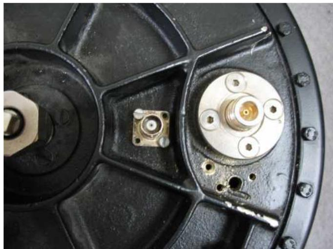
Cavité passe-bas : Percer une BNC sur la tangente au cercle de la prise N, au même rayon que le N.
