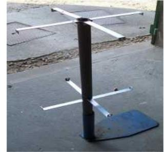
Attention les éléments du bas sont en une partie. Le boom est percé avec une scie à métaux afin d'y enfiler le plat alu.
