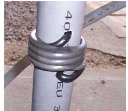
L'alimentation de l'antenne se fait avec du coaxial de 50 ohms et les deux boucles sont couplés par un morceau d'alu inséré entre les éléments et le boom.
