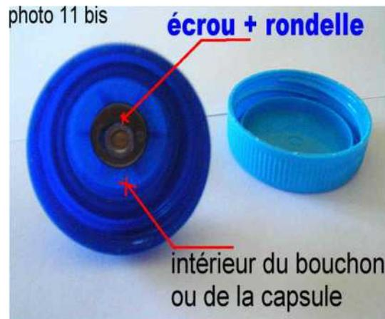
Voici un autre détail de la construction du P.T.O. : la fixation du bouchon d'eau minérale sur la vis en laiton. Ce système de fixation très simple est immobilisé définitivement avec quelques gouttes de colle cyanolite « Glue3 ». L'éventail des bouchons et capsules d'eau minérale est important comme le choix des diamètres. Sur la photo 10 bis le bouchon bleu fait 40 mm de diamètre, à considérer comme étant déjà important et bien en main.
