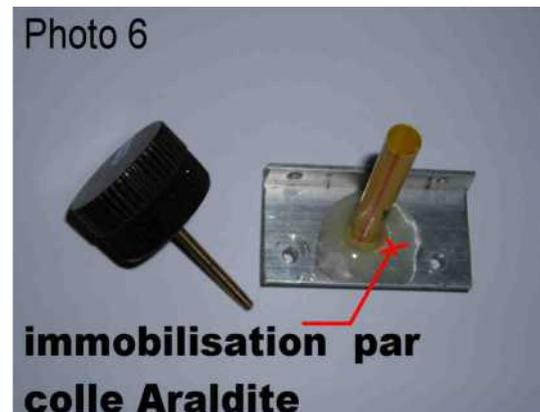
Le P.T.O est fixé sur une cornière en aluminium, profilé en équerre de 20 X 20 mm. Sur chaque face de l'équerre nous avons percé 2 trous Ø 4mm. Ainsi d'une part nous avons possibilité de fixer le P.T.O. en façade avec accès au bouton d'accord en commande extérieure et d'autre part fixation du circuit électronique avec transistors et autres composants de l'oscillateur.
