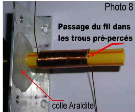
Lorsque le P.T.O. est bien collé, il faut envisager la méthode pour pouvoir fixer le bobinage enroulé sur la paille. La solution la plus est de percer tangentiellement avec une épingle photo 7 la paille, et passer dans les 2 trous percés avec l'épingle le fil du bobinage. A la fin de l'enroulement photo 8 nouveau perçage avec l'épingle et passage du fil dans les 2 trous.
