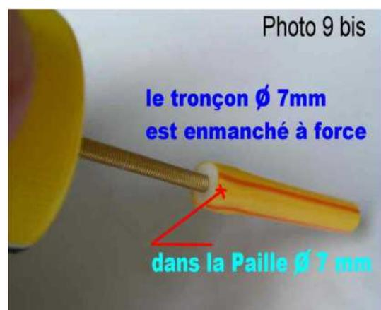
En phase finale on obtient une bague de  $\varnothing 7$ mm dont la forme sans être parfaitement cylindrique et légèrement hexagonale. L'opération finale consiste à enfoncer en forçant le tronçon (bague) de  $\varnothing 7$ mm dans la paille. La photo 9 bis nous montre le résultat obtenu. A l'usage la solidarité bague polyamide et paille sont très solides la matière plastique de la paille se rétracte sur la bague.
