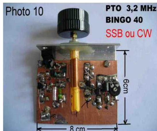
Voici les photos 9 et 10, deux exemples de P.T.O. oscillateur VACKAR sur 7 et 3.2 MHz.
