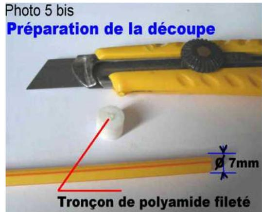
Lorsque le trou de  $\varnothing 2$  mm est percé on y insère en vissant à force ( auto-taraudage ou auto-filetage)
