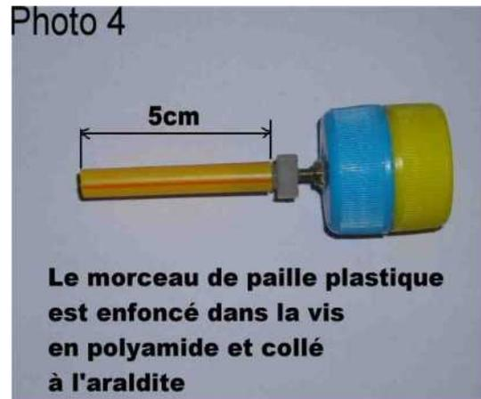
Les photos 3 et 4 informent sur une autre idée de concept du P.T.O., avec une vis en nylon de diamètre 6 mm. Le problème rencontré est la dureté du nylon qu'il faudra tarauder avec un véritable taraud de Ø 3 mm I.S.O. Cette solution est aussi à envisager. Quant à la fixation de la paille sur la vis nylon utiliser de la colle « Araldite » rapide.
