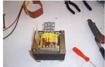
Alors qu'en fait, avec les pertes dues au débobinage cela provoque une chute de tension et d'intensité et nous pourrons avoir ainsi 10A de façon sûre.
