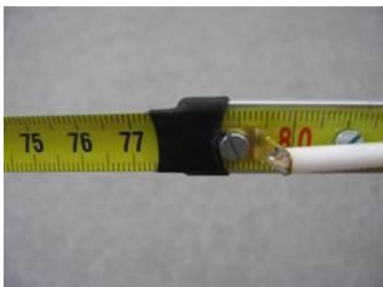
Pour réduire la contrainte au niveau des fixations des brins en mètre ruban, on peut mettre un manchon de gaine thermo-rétractable ou quelques tours de ruban adhésif.
