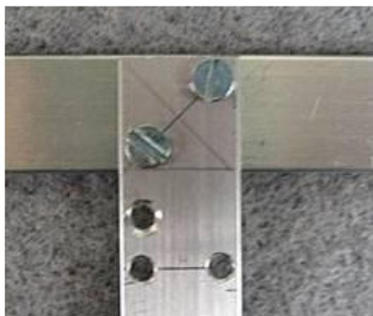
Sur l'armature centrale on y percera des trous de 4mm pour y fixer le récepteur et la poignée. Des trous de 3 à 3.5mm pour le cavalier du câble coaxial. L'assemblage de la structure se fait par deux vis de 3mm en diagonale des largeurs en regard. Le plus simple consiste à percer les deux trous. Puis, sur l'armature centrale reporter l'un des deux trous sur le brin superposé, percer et visser. Vérifier l'équerrage puis percer les 2èmes trous et mettre la 2e vis qui bloquera le tout.
