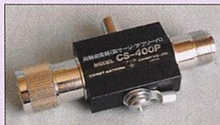
Protéger la station contre la foudre n'est pas une mince affaire. Parmi les solutions existantes, on pourra retenir ce parafoudre qui s'insère dans le câble d'antenne. Il est donc équipé de connecteurs coaxiaux (type PL/SO), est utilisable entre 0 et 500 MHz et accepte jusqu'à 500 W PEP.
