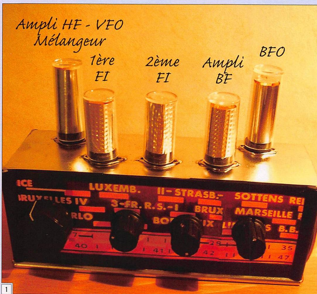
Les postes TSF à tubes présentent l'avantage de pouvoir suivre visuellement le "parcours" de nos ondes, de l'antenne au HP, en passant par les amplis FI et autres détecteurs spécifiques. À l'inverse, les récepteurs modernes apportent une telle intégration de fonctions dans un simple CI qu'il est bien difficile d'appréhender, pour un néophyte, le fonctionnement de ces appareils.
