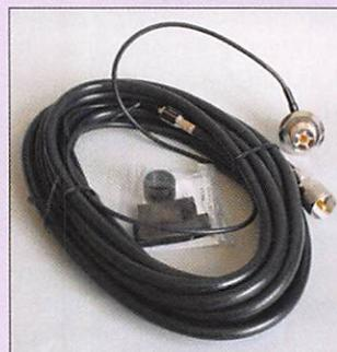
Cet accessoire se compose de 5 m de câble de bonne qualité, 11 mm de diamètre, prolongés par 1 m de RG-174. Le coaxial le plus gros est terminé par PL-259, le plus fin est équipé d'une prise SO-239 qui servira de support d'an-
