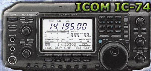
Emetteur-récepteur HF, 50 et 144 MHz, tous modes. DSP FI 32 bits, keyer et coupleur automatiques intégrés, démodulateur RTTY, large écran LCD, 102 mémoires, puissance de 100 W, etc...
