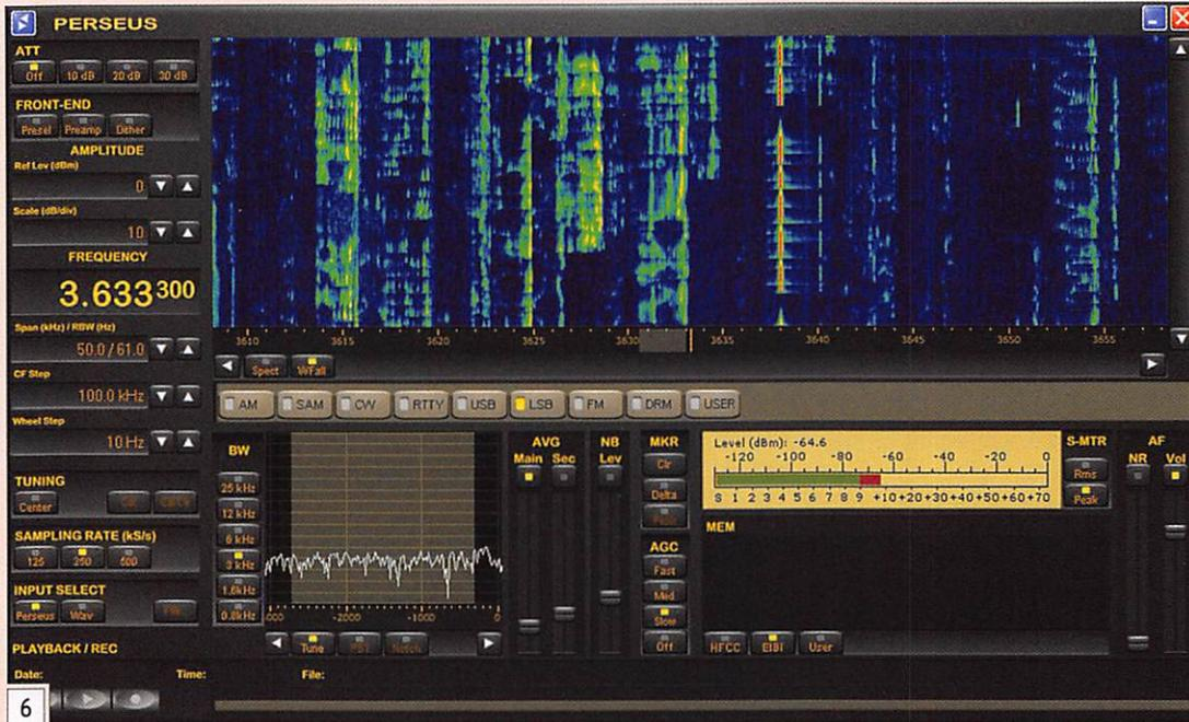
(à la souris) l'échelle qui se trouve sous l'affichage panoramique principal. De même, on peut modifier la fréquence en agissant sur la molette de la souris (au pas programmé par le réglage "Wheel step"). L'utilisateur dispose ainsi de ressources différentes pour agir sur la fréquence à écouter.
