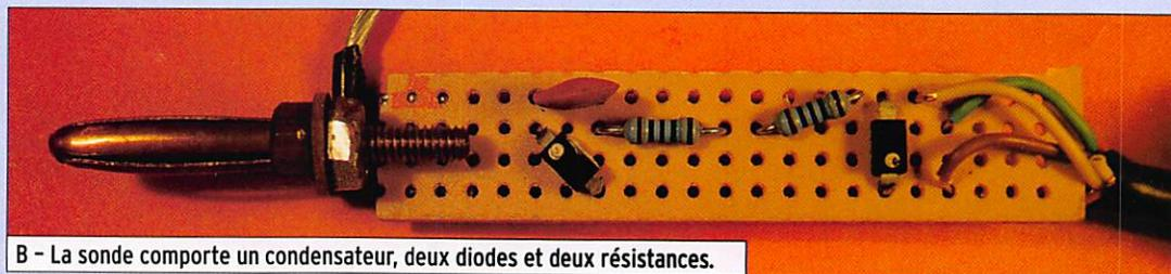
B - La sonde comporte un condensateur, deux diodes et deux résistances.
