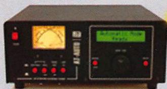
**AT-AUTO** Boîte d'accord automatique, 1,8 à 30 MHz, 1500 W (CW), avec self à roulette motorisée, écran digital, lecture à aiguilles croisées, port série pour mise à jour du processeur par PC sur le site Palstar, alimentation secteur fournie... **PRIX : 1450 €**
