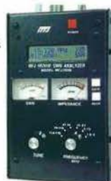
MFJ 259B Analyseur d'antennes de 1,8 à 170 MHz. Fréquencemètre 10 digits + affichage ROS et résistance HF par galvanomètres. Mesure des impédances complexes. Utilisation en fréquencemètre. MFJ-66 — Adaptateur dipmètre pour MFJ-259.
