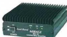
BD-35 Mirage Amplificateur linéaire VHF/UHF. Sortie 45 W (VHF) et 35 W (UHF) pour 1 à 7 W d'excitation. Sélection automatique de bande. Commutation automatique émission/réception. Fonction full-duplex.
