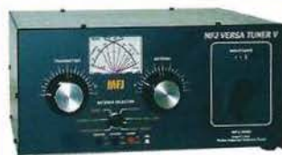
MFJ 989D Boîte d'accord pour antennes HF. Nouveaux CV et self à roulette. Commutateur pour lignes coaxiales, symétrique ou filaire. Charge incorporée. Wattmètre à aiguilles croisées.
