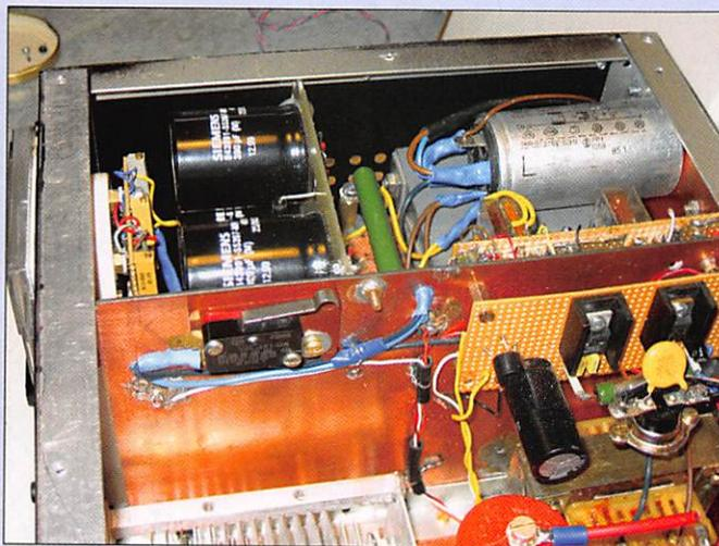
alternative permet de chauffer les filaments, mis en parallèle, sous 0,6 A. Cette tension est ajustée à la valeur correcte de 40 V après chute de tension dans les résistances de 15  $\Omega$  et 4,7  $\Omega$  en série dans le circuit. Un thermostat, fixé contre la résistance de 15  $\Omega$ , permet la mise en marche du ventilateur dès que la température dépasse 60° et assure la ventilation
