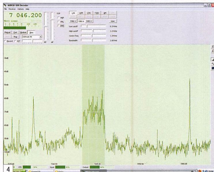
Le logiciel dispose d'un RIT, d'un contrôle de CAG (que l'on peut placer également sur manuel), d'un gain HF et d'un gain BF. Les fréquences de coupure haute et basse ainsi que la fréquence centrale des filtres sont ajustables. Plusieurs filtres sont prédéfinis, dont un est laissé à l'initiative de l'utilisateur.
