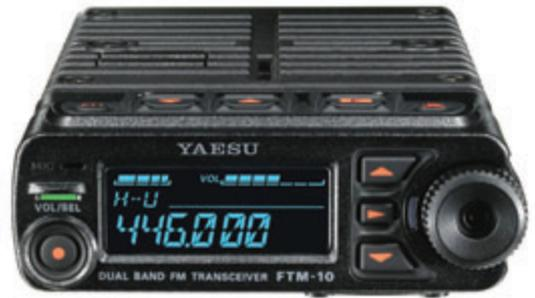
vre les bandes 144 et 430 MHz en FM et dispose d'une réception élargie (de 0,5 à 1000 MHz) avec les modes AM et WFM (et stéréo). Délivrant une puissance émission
