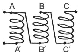
Figure 2 - Construction de TR1 et TR2.
