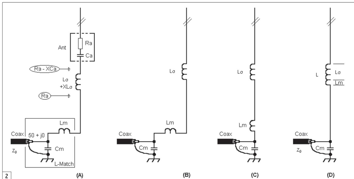
parle généralement de circuit en L à cause de l'orientation des éléments. Au-delà il s'agit de circuits en T, en PI, en PI-L par exemple.
