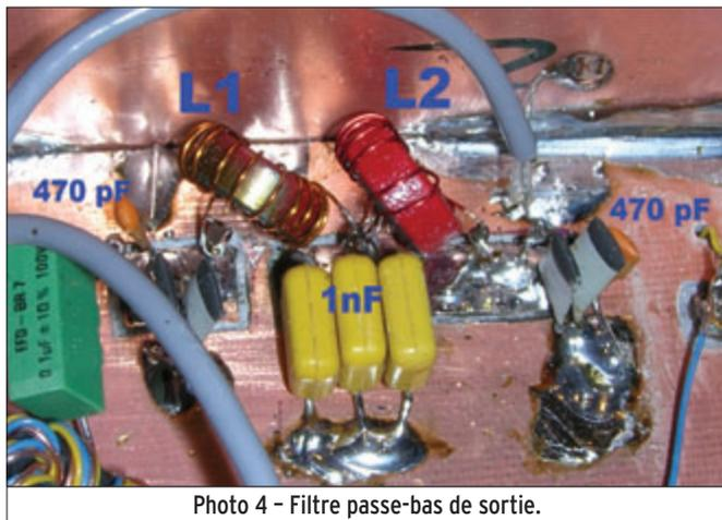
Photo 4 - Filtre passe-bas de sortie.
