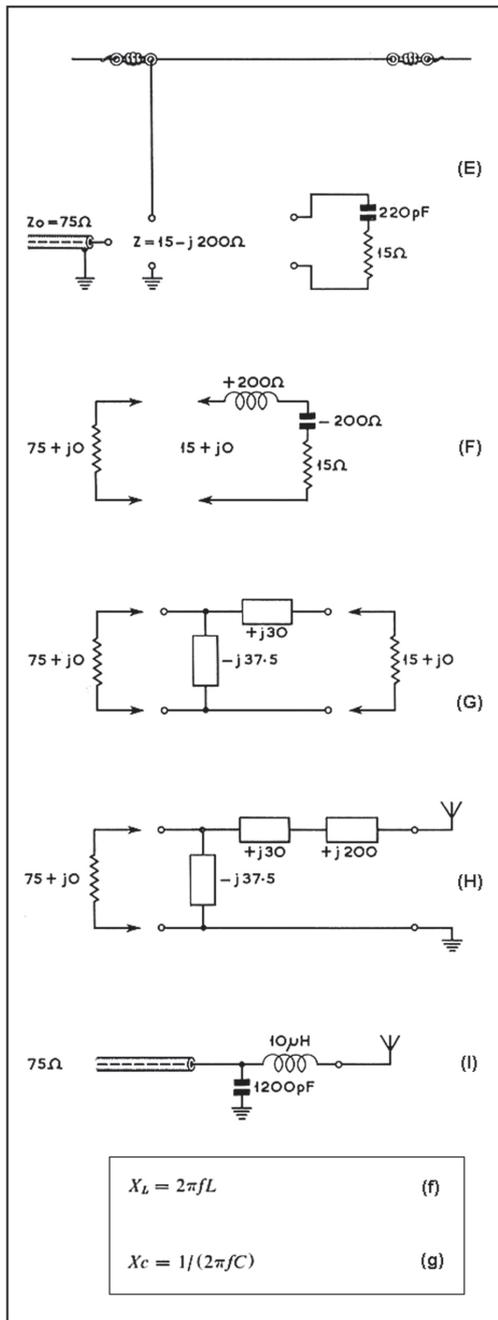
subsiste la résistance de 15 ohms à adapter aux 75 ohms souhaités (figure 3F).
