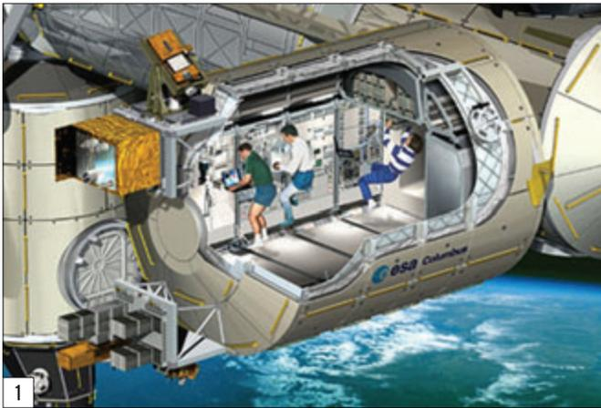
**L**e laboratoire peut contenir 10 bâtis de charges utiles standardisées (ISPRs pour International Standard Payload Racks) de type scientifique. Le module sera fixé au nœud de jonction numéro 2 (module Node 2). Ce module doit être envoyé par la navette Atlantis en septembre 2007. Le laboratoire est contrôlé au sol à partir du Centre de contrôle Columbus, se trouvant dans les locaux du Centre allemand d'opérations spatiales (GSOC), à Oberpfaffenhofen.
