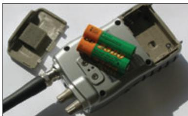
4 - La face arrière du PRO-83. Ce récepteur fonctionne avec 2 accumulateurs ou 2 piles au format R6. Un petit inverseur à glissière dans le compartiment pile permet de mettre en fonction le chargeur par la prise d'alimentation extérieure (6 V - 300 mA).
