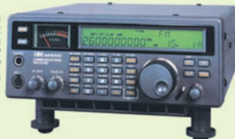
**AR-5000A** – Récepteur semi-professionnel 10 kHz à 3000 MHz. AM/FM/USB/LSB/CW. 10 VFO. 2000 mémoires. 10 banques de recherche. 1100 fréquences Pass. Filtres 3, 6, 15, 40, 110 et 220 kHz (500 Hz en option).
