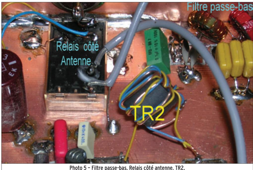
Photo 5 - Filtre passe-bas. Relais côté antenne. TR2.
