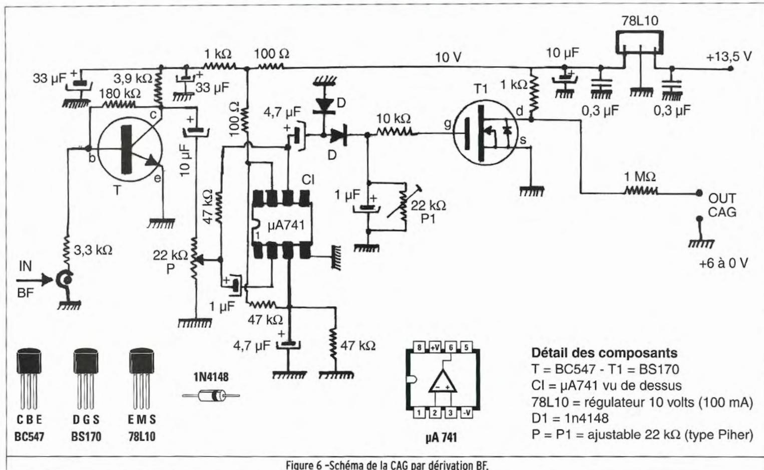
Figure 6 - Schéma de la CAG par dérivation BF.
