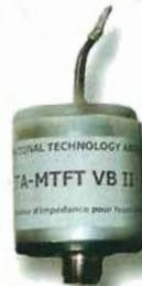
**ITA MTFT** : Abaisseur d'impédance 1:9 bobiné sur véritable torse de ferrite HF pour construire des antennes "long fil", peu onéreuses et destinées à un usage ponctuel : week-end, vacances, etc. Puissance max. : 300 W PEP. Utilisation avec boîte de couplage recommandée selon la longueur du fil (minimum 5,5 m).
