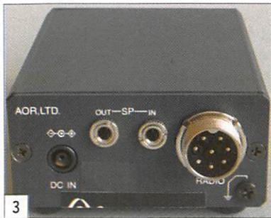
Le signal BF de l'E/R passe par l'ARD9000 qui en contrôle le volume uniquement en mode numérique, pas en mode analogique. Dans la prise HP OUT du modem, vous devez mettre un HP extérieur ou un casque car bien entendu, la prise casque de votre transceiver continue à véhiculer un signal qui ne sera pas décodé !
