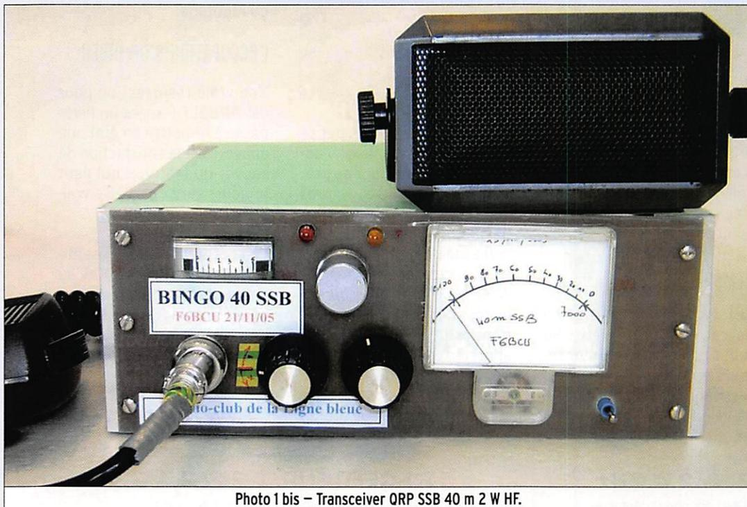
Photo 1 bis - Transceiver QRP SSB 40 m 2 W HF.
