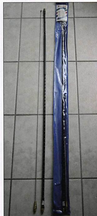
Encore une antenne mobile, pour terminer cette série. Dans la gamme Pro-Am, on trouve une série de fouets bobinés monobandes et performants, acceptant 250 W PEP, comme ce modèle 40 m dont la hauteur atteint quand même 2,45 m (rançon d'un bon rendement). La sortie s'effectue sur un connecteur
