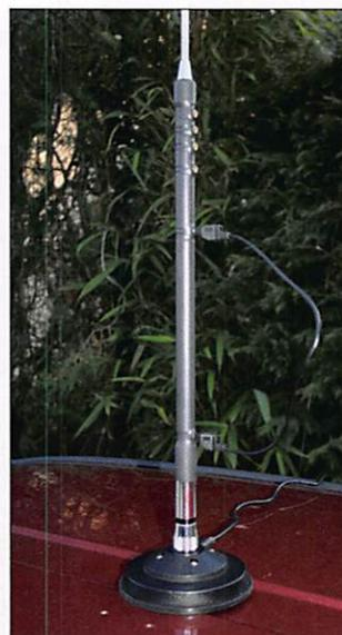
dont on réglera la hauteur afin d'obtenir un creux de ROS sur la partie voulue de la bande. La hauteur de l'ensemble avoisine 1,75 m. Cette antenne, qui accepte 120 W, peut être montée sur un support magnétique, elle a été spécialement conçue pour cela. Son prix est de 99 euros, toujours chez RCC.
