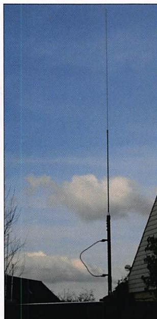
elles que l'on sélectionne la bande de trafic souhaitée, en déplaçant un court-circuit (petit câble doté de deux fiches bananas que l'on voit sur la photo). La partie supérieure est un brin en acier, coulissant,
