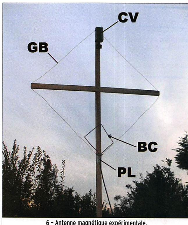
6 - Antenne magnétique expérimentale.
