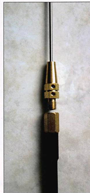
américain (3/8) sur lequel on peut monter un adaptateur PL. Pour le modèle présenté, la bande passante approche les 60 kHz, avec un ROS de 2:1 aux extrémités. La partie bobinée est assemblée au fouet par un dispositif à vis. La résonance est obtenue en déplaçant un brin coulissant serré par un écrou 6 pans. À voir chez RCC.
