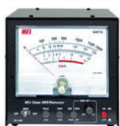
MFJ 868 Wattmètre grande taille à aiguilles croisées 1,8 à 30 MHz, 20/200/2000 W.
