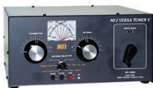
MFJ 989D Boîte d'accord pour antennes HF. Nouveaux CV et self à roulette. Commutateur pour lignes coaxiales, symétrique ou filaire. Charge incorporée. Wattmètre à aiguilles croisées.
