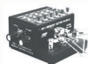
MFJ 490 Manipulateur double contact. Générateur de messages commandé par menu.
