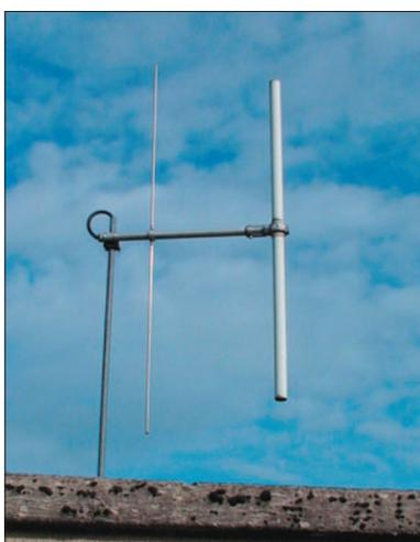
5 – Antenne composée d'un réflecteur et d'un radiateur.
