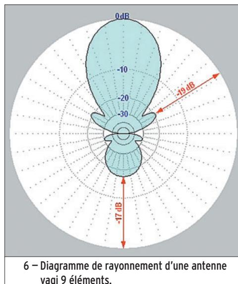
6 – Diagramme de rayonnement d'une antenne yagi 9 éléments.
