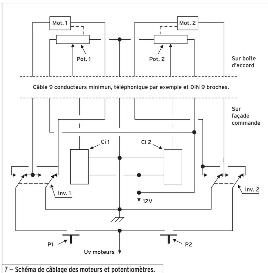
7 – Schéma de câblage des moteurs et potentiomètres.
