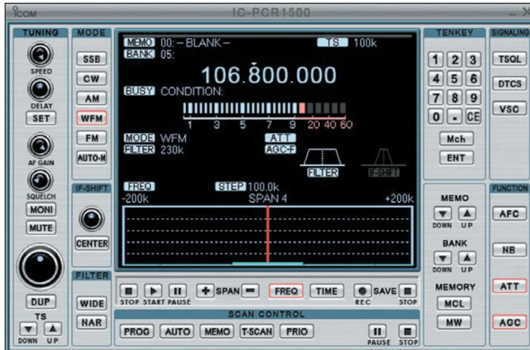
seulement les banques mémoires sélectionnées... et sauter les fréquences que l'on veut éviter. La condition de reprise du scanning est programmable (timer ou disparition du signal). Trois fréquences prioritaires peuvent être programmées, elles seront alors écoutées régulièrement, en alternance avec le VFO ou pendant le scanning.
