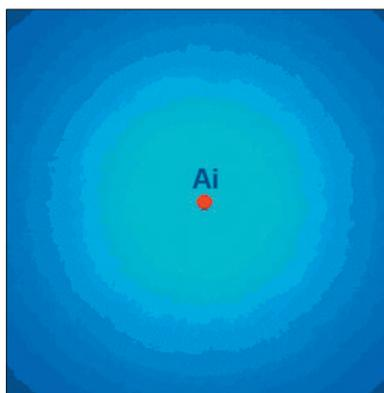
2 – Rayonnement de l'antenne isotrope.
