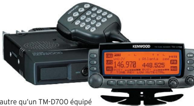
autre qu'un TM-D700 équipé de l'APRS. Pour le reste, les fonctions et les puissances de sortie de ce bibande V/UHF FM (avec réception élargie) sont identiques à celle de son frère aîné sorti en l'an 2000. Les deux appareils sont du reste si semblables qu'il est difficile de les différencier sur une photo de petite taille.
