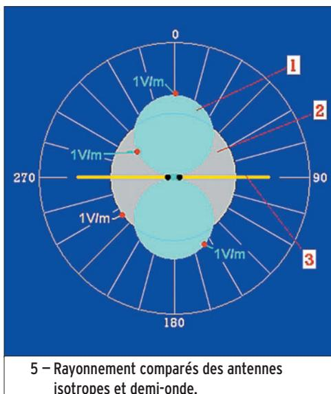
5 – Rayonnement comparés des antennes isotropes et demi-onde.
