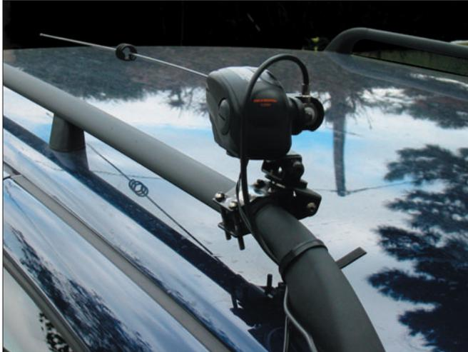
Décliné en différentes versions (gouttière, malle de coffre, barres porte-bagages), ce support d'antenne s'avère bien pratique pour le montage d'un fouet VHF/UHF sur un véhicule équipé d'un porte-bagages de toit. Motorisé, le support en question
