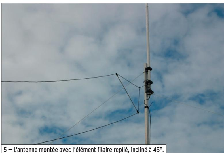
5 – L'antenne montée avec l'élément filaire replié, incliné à 45°.
