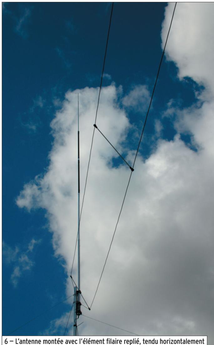
6 – L'antenne montée avec l'élément filaire replié, tendu horizontalement
