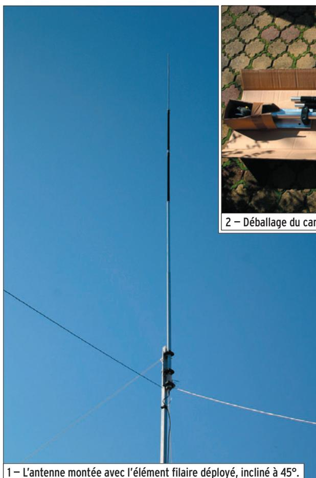
1 – L'antenne montée avec l'élément filaire déployé, incliné à 45°.
