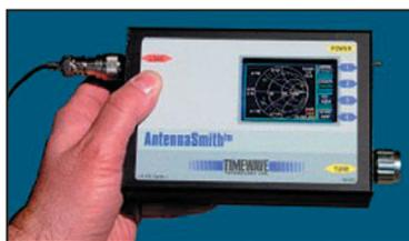
Timewave met sur le marché le TZ-900 "AntennaSmith", un analyseur d'antenne graphique, capable d'afficher l'abaque de Smith. Cet appareil, doté d'un écran couleur, fonctionne entre 0,5 et 60 MHz. Il affiche le ROS, l'impédance, la réactance, le coefficient de réflexion et l'abaque de Smith. Portable, solide, très compact, il peut être relié à un PC et piloté par logiciel. D'après les informations four-
