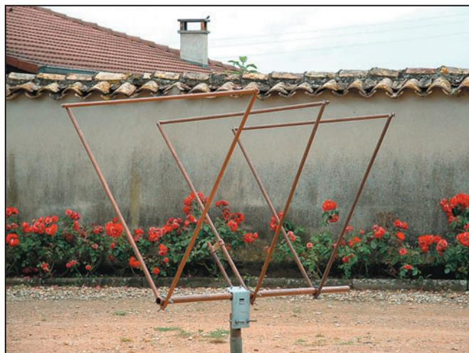
2 - L'antenne 3 éléments, "prototype" en cuivre.
