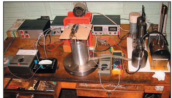
vention de la triode par Lee De Forest en 1906, il se lance dans la fabrication de la mythique TM mise au point par le Général Ferrié en 1915. Faire une lampe, ce n'est pas si facile, mais pour corser un peu la difficulté, F2FO va construire tout le nécessaire à ce projet, et en particulier diverses pompes, dont une moléculaire, afin d'obtenir un vide permettant l'emploi en émission des tubes réalisés. Une dizaine de lampes vont ainsi voir le jour...
