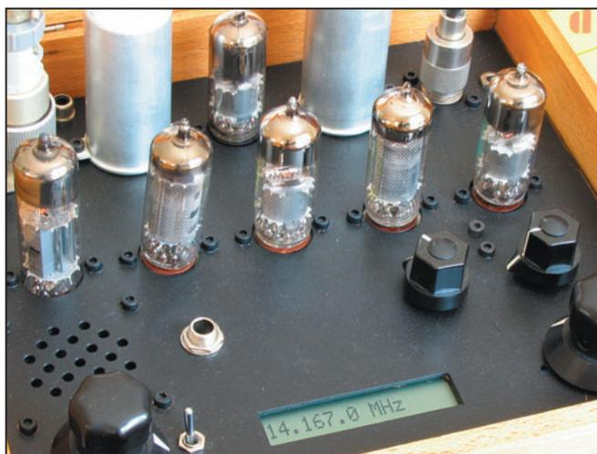
geuse intermodule terriblement. Toujours pour éviter les risques d'intermodulation, le potentiel continu de la grille 1 reste fixe, sans tension de CAG.
