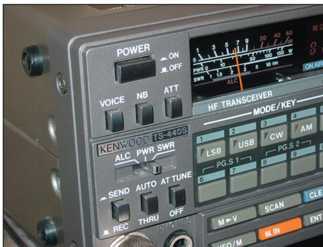
10 - Dans l'angle supérieur gauche de la façade, proche du BP de mise en route, se trouve le BP "Voice". Si l'option VSI (Voice synthesizer) n'est pas montée, ce bouton-poussoir est disponible pour piloter le DSP.
