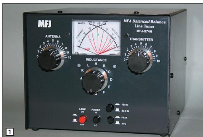
si l'on peut éviter le balun et son tore en guise de sortie symétrique, pourquoi s'en priver ? La solution retenue par les anciens radioamateurs a du bon. Le problème, c'est qu'elle est un peu plus difficile à mettre en œuvre et, surtout, demande un CV double, une denrée de plus en plus rare. Nous allons voir, à l'examen des entrailles du MFJ-974H, que le CV double a été ici remplacé par deux CV identiques couplés mécaniquement...
