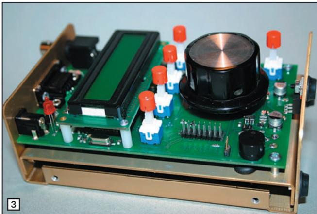
(**figure 5**). Le ZM-30 détermine le signe de la réactance et vous indiquera si votre antenne est capacitive ou inductive ce qui vous permettra de savoir immédiatement s'il faut l'allonger ou la raccourcir pour l'amener à résonner sur la fréquence de votre choix.
