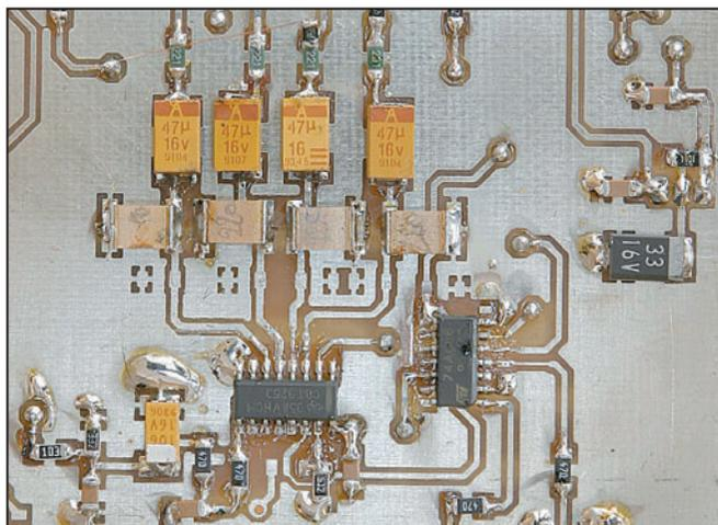
sera nécessaire de supprimer une des deux bandes latérales. Plusieurs méthodes peuvent être mises en œuvre, parmi lesquelles le réseau polyphase qui est utilisé ici.
