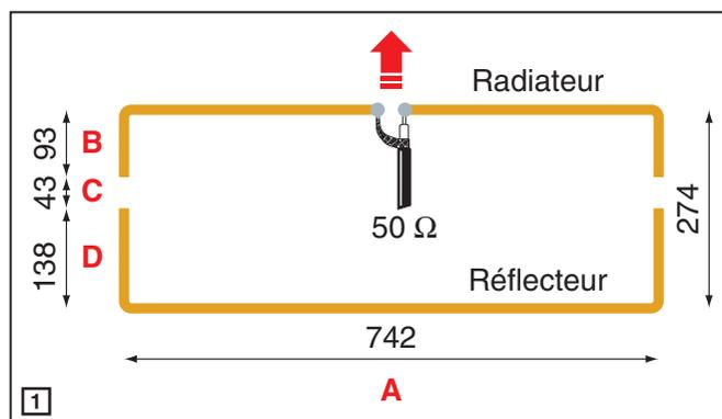
certain rapport vis-à-vis de la longueur d'onde. On conçoit qu'en VHF, ces données soient encore plus importantes, d'où la mise en garde effectuée plus haut : respecter les cotes fournies par l'auteur pour du tube de cuivre de diamètre 8 mm. Toutes ces cotes sont données "d'axe à axe des tubes". Les principaux problèmes qui se poseront aux réalisateurs de cette antenne concernent le pliage des tubes et le respect de l'écartement (marqué C sur le dessin).
