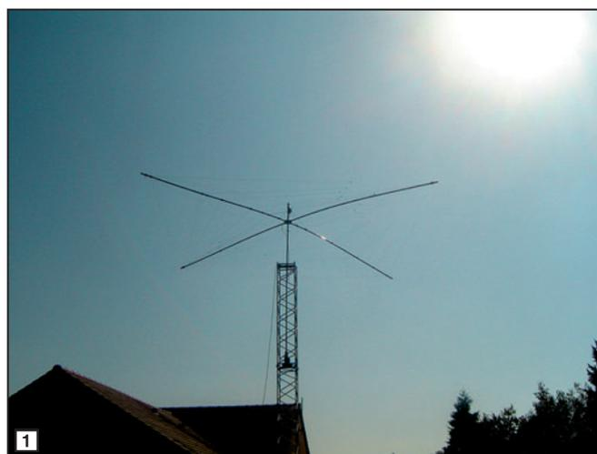
antenne particulière, conçue par G4ZU, appelée "bow-and-arrow beam" (ou "Bird-Yagi"), antenne Yagi de trois éléments dont les directeur et réflecteur sont courbés en forme de V, et ne trouvant nulle part dans la littérature ce style d'antenne en multibandes, Cornélius a décidé de commencer à en développer une.
