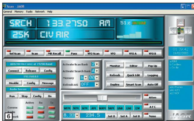
difficulté. Le même essai, pratiqué sur un fil de 5 mètres est bien plus probant (moins d'intermodulation). L'écoute des VOLMET sur 3, 5, et 8 MHz permet de vérifier la bonne stabilité du récepteur. Le pas le plus fin est de 50 Hz, ce qui permet un calage satisfaisant. La bande passante du filtre utilisé en BLU est de 3 kHz.
