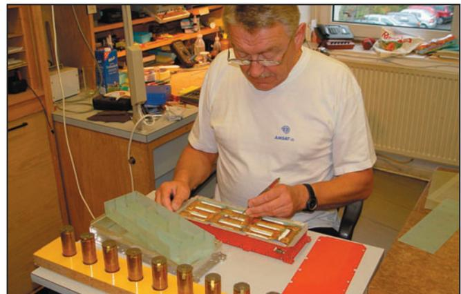
13 - Assemblage d'un module batterie.
