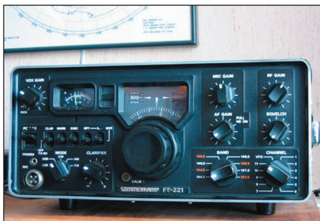
Un transceiver VHF multimodes déjà ancien mais toujours vaillant, le FT-221.
