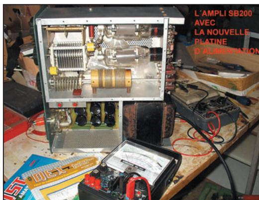
Figure 1: L'amplificateur ouvert et modifié.
