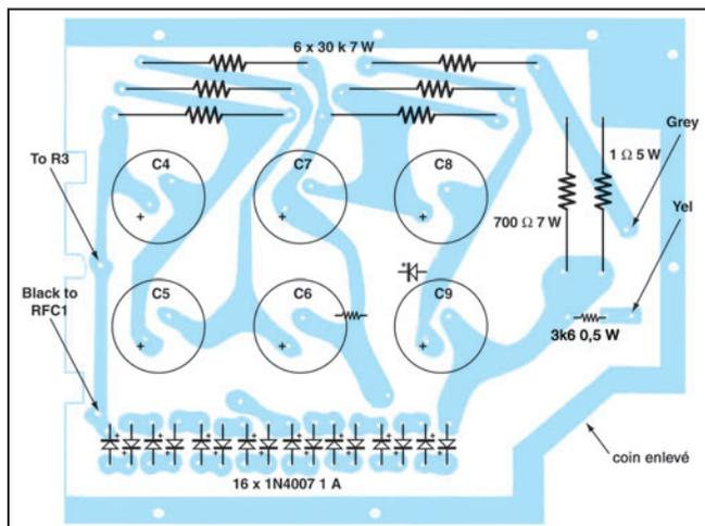
Figure 6: Implantation des composants sur la platine.
