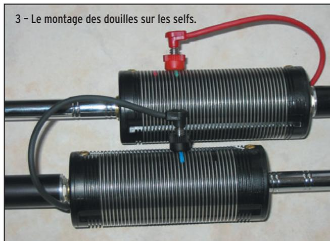
3 - Le montage des douilles sur les selfs.
