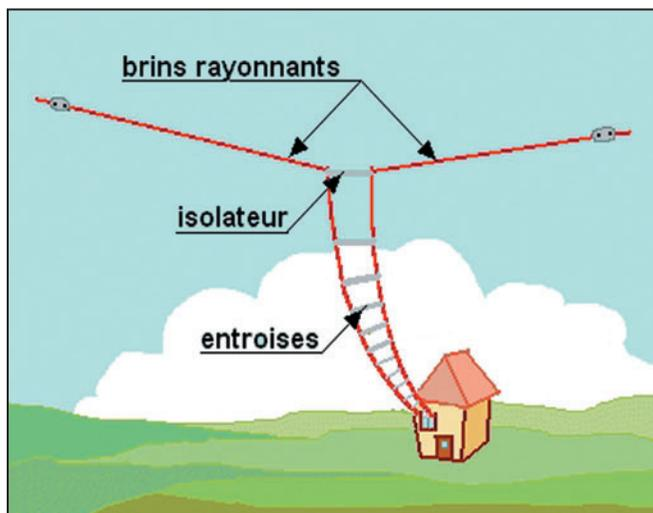
Figure 5: Alimentation d'un dipôle avec une ligne bifilaire.
