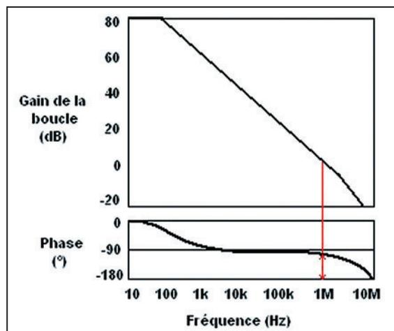
Figure 3: Diagramme de Bode d'un régulateur NPN.
