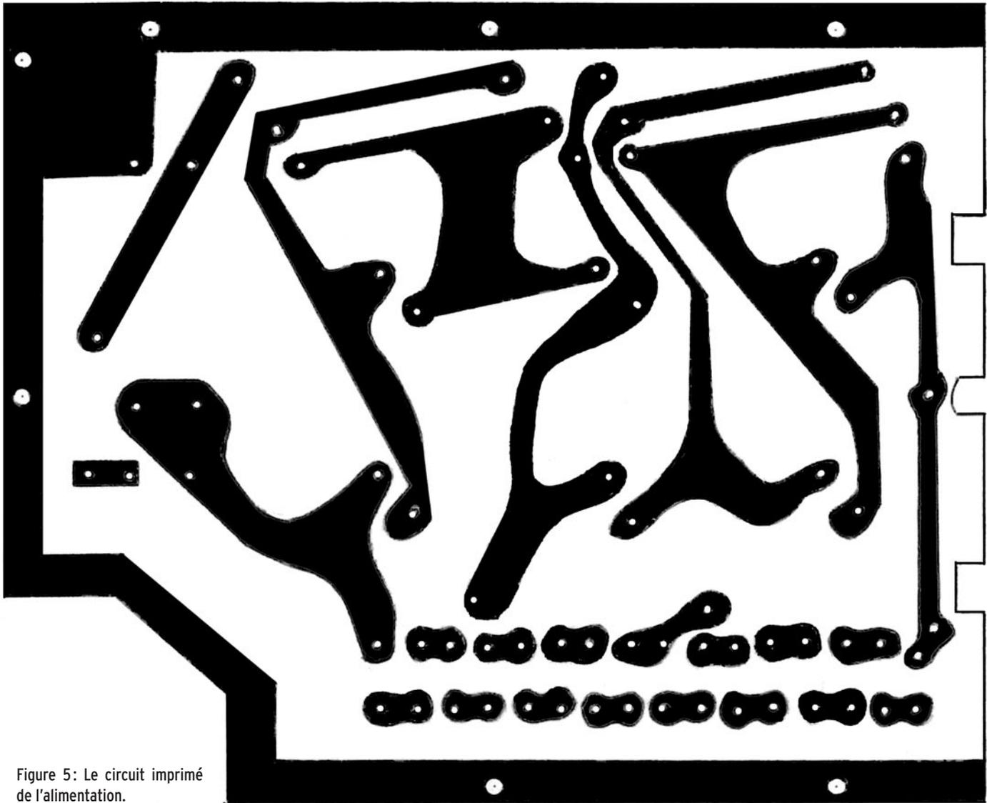
Figure 5: Le circuit imprimé de l'alimentation.
