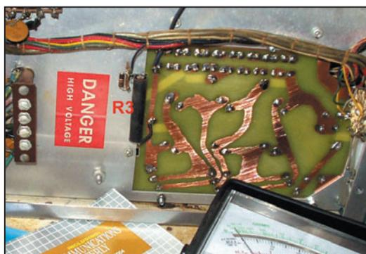
Figure 4: Le nouveau circuit imprimé mis en place.
