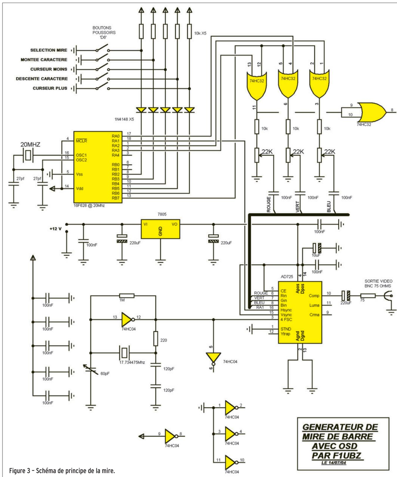
Figure 3 - Schéma de principe de la mire.
