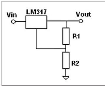
Figure 14: Mise en œuvre du LM317.
