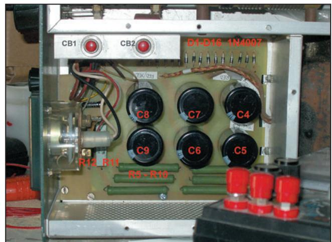
Figure 7: Vue des composants sur la platine modifiée.
