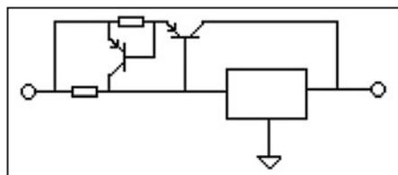
Figure 17: Transistor ballast externe avec limitation de courant.
