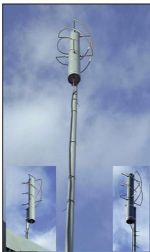
Fig. 11 - Vue générale des antennes Quadrifillar Helix (GOHPO).
