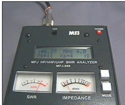
Photo 5 - Un impédancemètre d'antenne.
