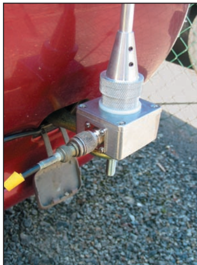
3 - Mise en place de l'embase de l'antenne.
