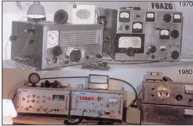
Les stations "OM" de Guy F6AZG : celle de 1970 fonctionnait en AM et CW, celle de 1980 en BLU et CW. Les deux récepteurs possèdent une visu panoramique... Deux superbes réalisations !
