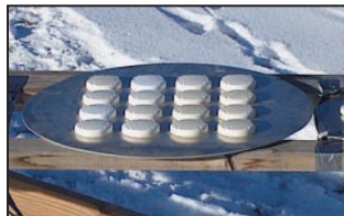
3 - Antenne directive électronique pour récepteur GPS.
