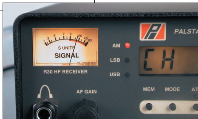
3 - Un S-mètre analogique lisible. Notez, sur le LCD, l'affichage en mode "MEM".
