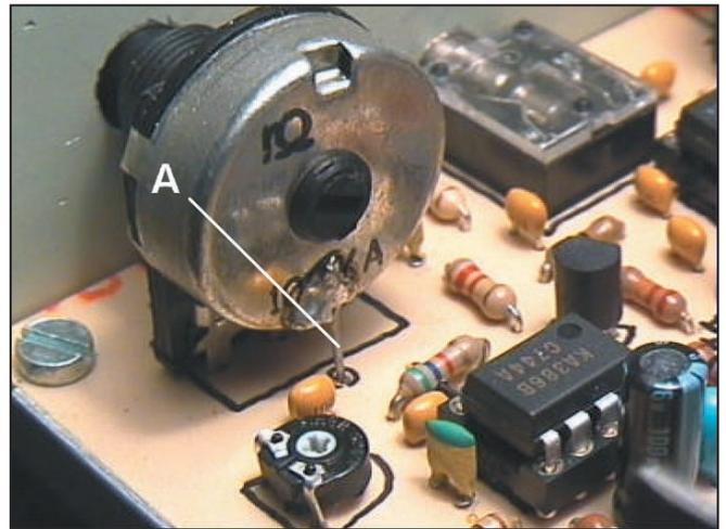
Figure 6 : Fixation du potentiomètre R3 sur le circuit.
