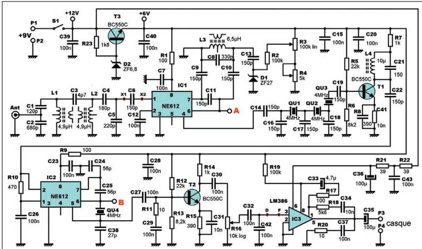
Figure 2: Le schéma du récepteur sans le préampli.
