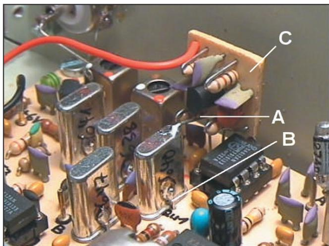
Figure 3: Fixation et raccordement du préampli HF.
