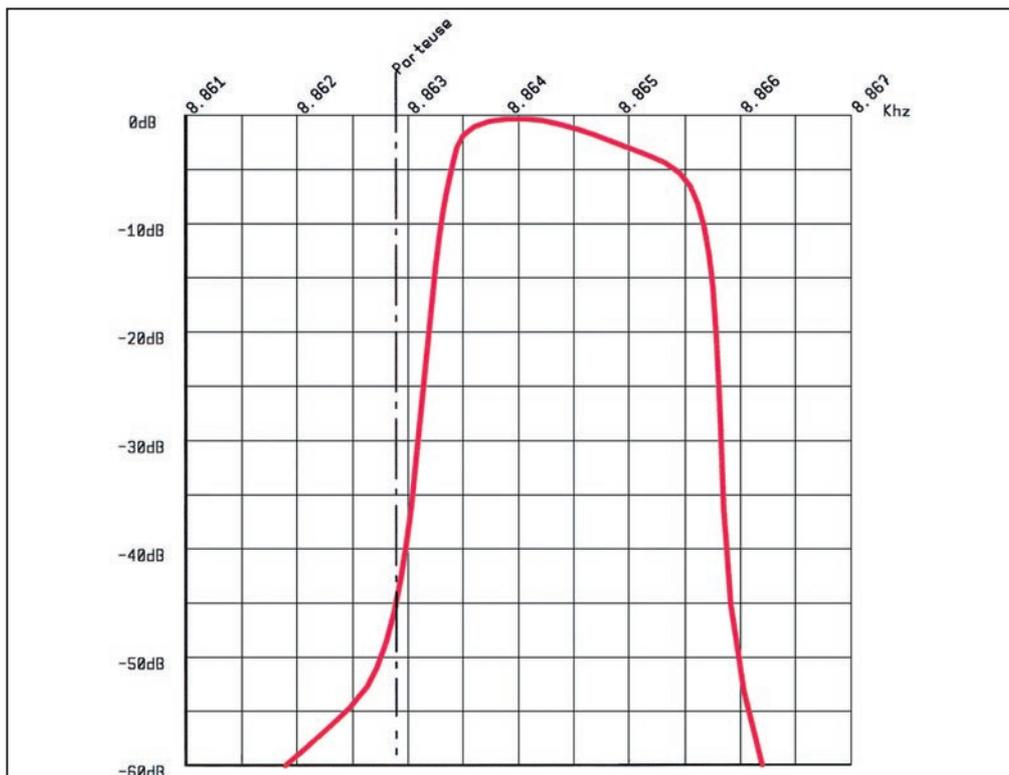
num de signal. On relèvera ensuite la courbe point par point, en faisant varier la fréquence autour de cette valeur et en notant le niveau de sortie (bien vérifier qu'au maximum on ne sature pas le MC1350!).
