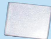
Cette antenne directive patch offre un gain de 8,5 dB. Elle s'utilise en réception aussi bien qu'en émission et permet d'augmenter considérablement la portée des dispositifs RTX travaillant sur des fréquences. Ouverture angulaire: 70° (horizontale), 65° (verticale). Gain: 8,5 dB. Câble de connexion: RG58. Connecteur: SMA. Impédance: 50 Ω. Dim.: 54 x 120 x 123 mm. Poids: 260 g.
