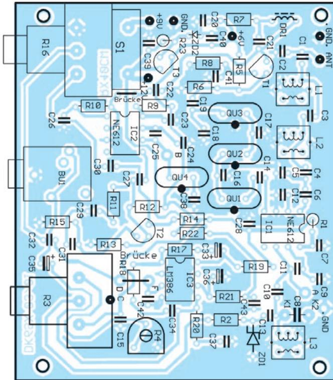
Figure 5 : Implantation des composants sur la platine principale.
