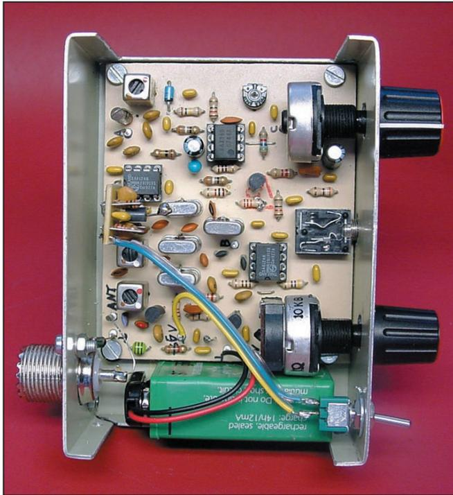
Figure 8 : La platine principale montée dans le boîtier.
