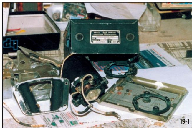
caisse, puis introduire le BC-312 N dans sa boîte d'origine en nettoyant, à la lame de rasoir, les stries des 5 boutons métalliques de fixation pour empêcher le BC-312 de s'échapper de la boîte de fonction.
