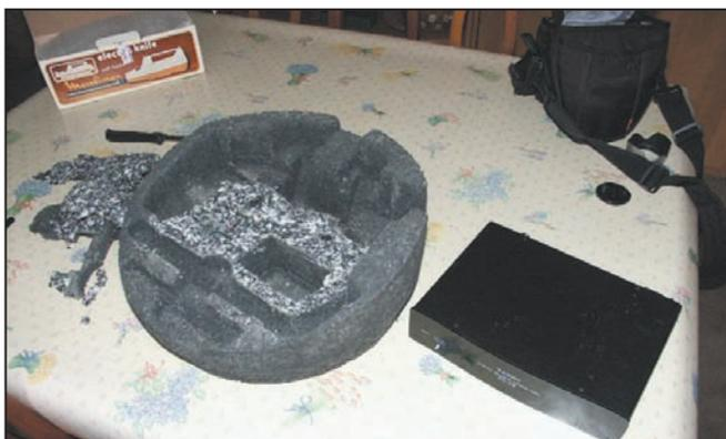
film transparent qui se met au-dessus des plats, vous faites un gabarit aux dimensions de votre émetteur, vous mettez le film dans le fond de la jante, le gabarit également enrobé dans du film, au milieu à la hauteur qui va bien, et vous remplissez avec la mousse. Attention de pas trop en mettre, ça gonfle!
