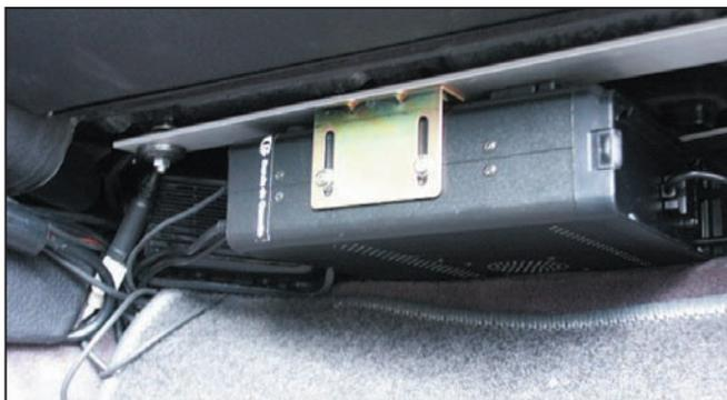
Pour la partie émetteur, j'ai fait un support avec des cornières d'aluminium achetées au magasin de bricolage du coin, support que j'ai ensuite repris sur les fixations en fer des caches en cartons qui se trouvent sous le tableau de bord. Bien sûr, il y a d'autres endroits dans l'auto où l'on peut mettre la partie émetteur mais, dans mon cas, c'était la meilleure solution.
