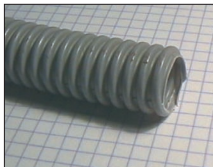
Figure 2: Gaine électrique annelée pour faire des supports.
