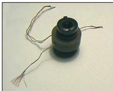
Figure 3: Bobinage HF formé de fil multibrin.
