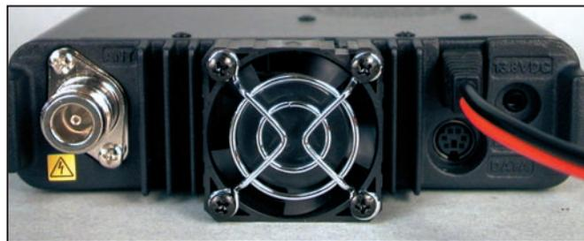
4 - Le panneau arrière, notez le connecteur antenne de type N.
