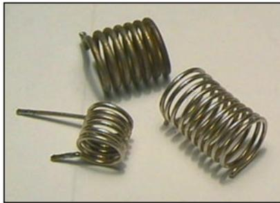
Figure 5 : Bobines en fil de cuivre argenté.
