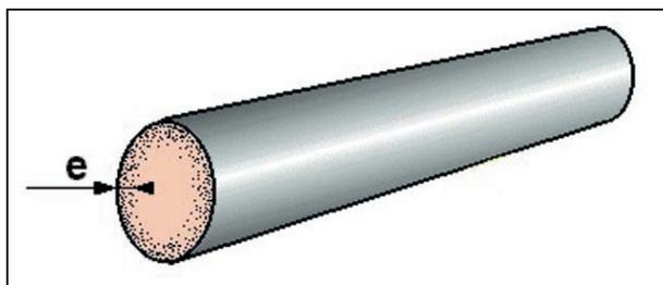
Figure 1: Répartition d'un courant HF dans un conducteur.
