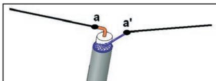
Figure 5: Raccordement d'un câble coaxial à un dipôle.
