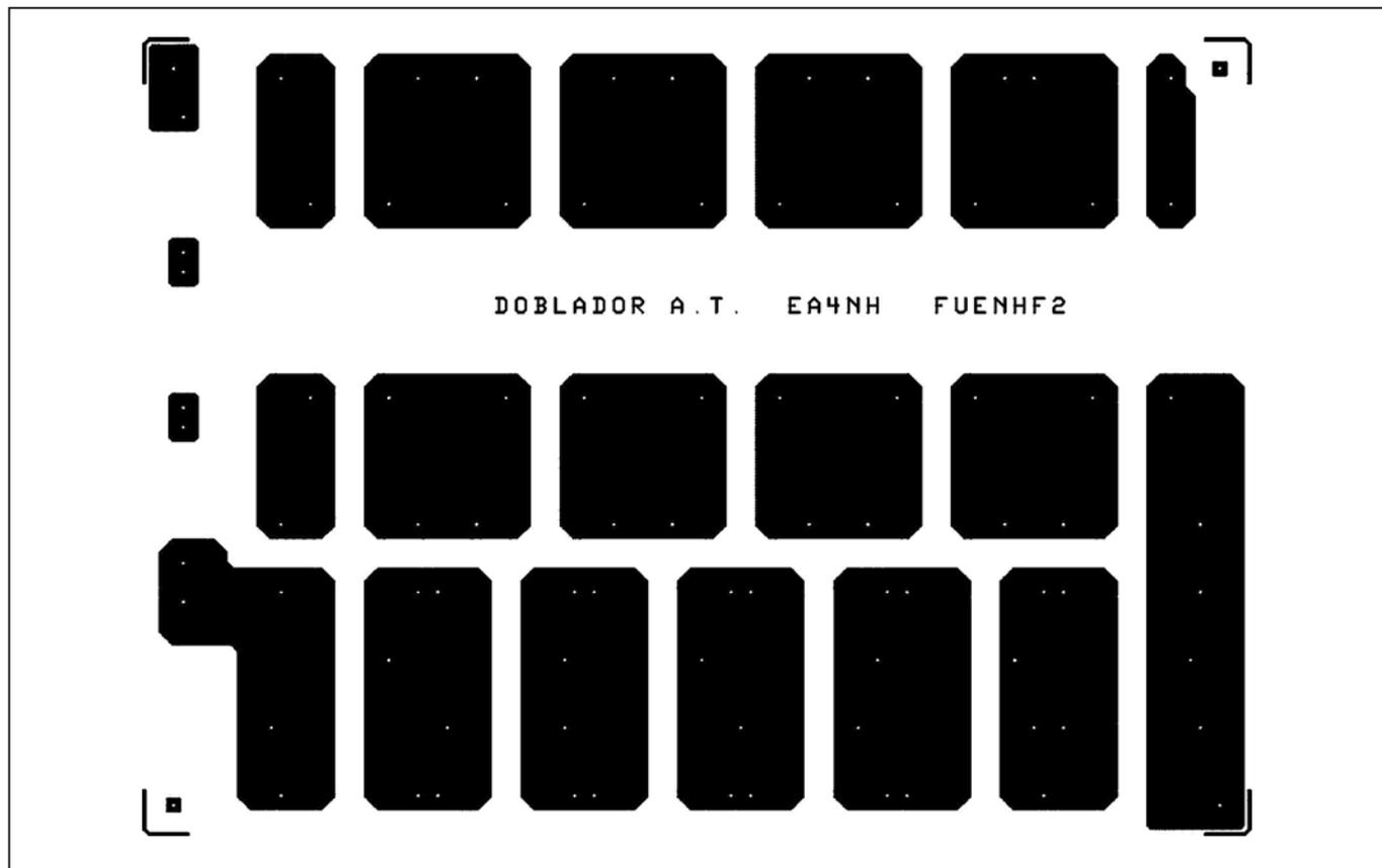
Figure 3 : Circuit imprimé du doubleur.
