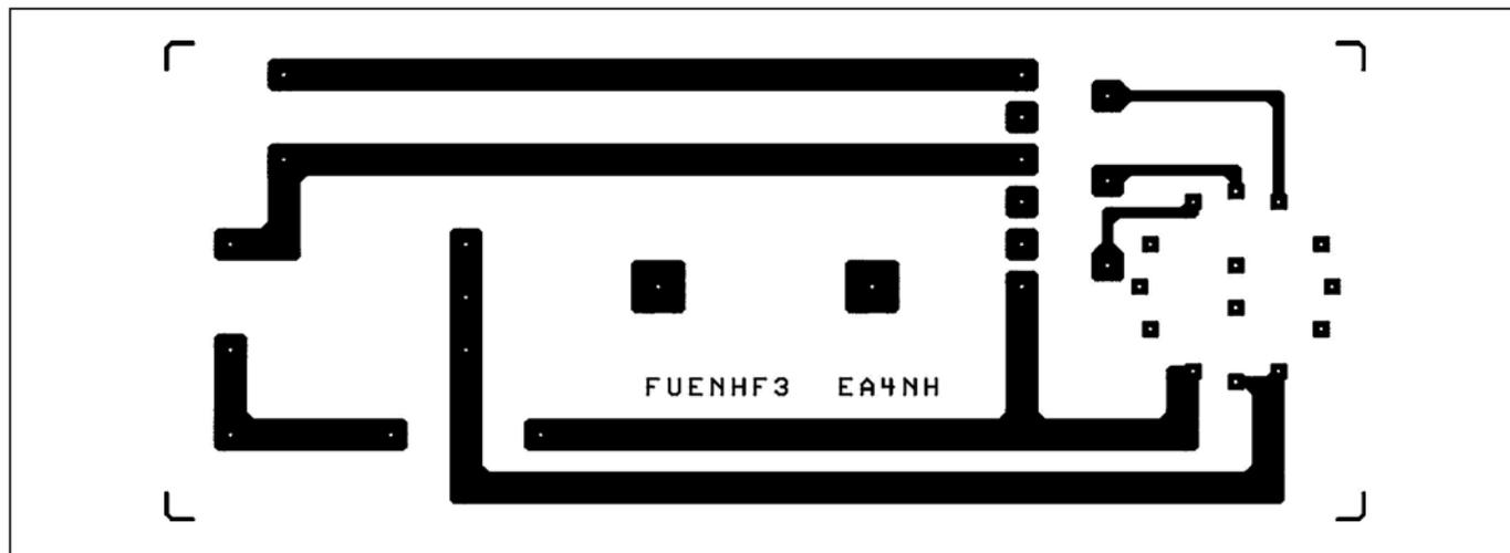
Figure 5: Circuit imprimé du circuit du contrôleur.
