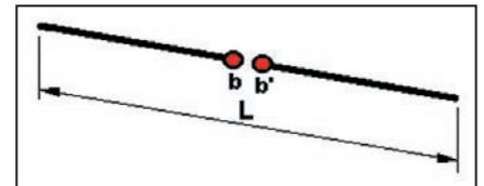
Figure 2 : L'antenne dipôle demi-onde.
