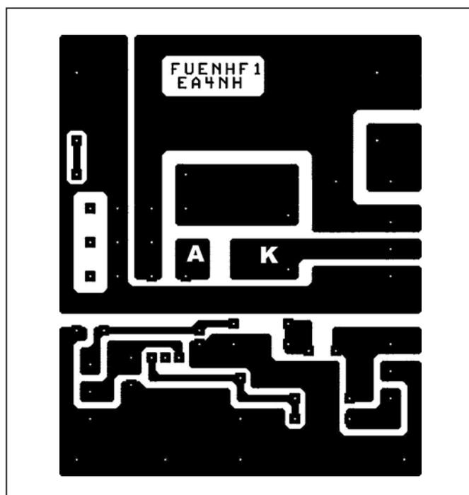
Figure 4 : Circuit imprimé du circuit du relais.
