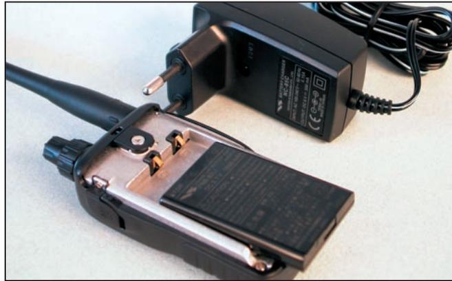
2 - La batterie, très plate, de 1 000 mAh et le chargeur fourni.
