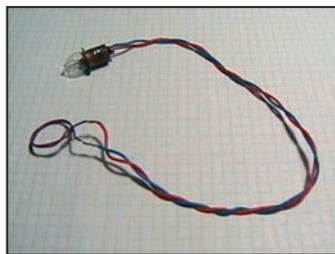
Figure 7: Utilisation de la ligne bifilaire torsadée.
