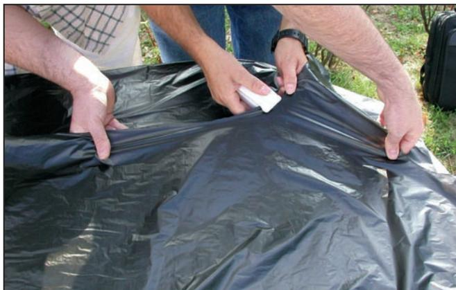
1 - Soudure à chaud du plastique de l'enveloppe.
