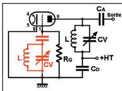
Figure 5: L'oscillateur à grille et plaque accordés.
