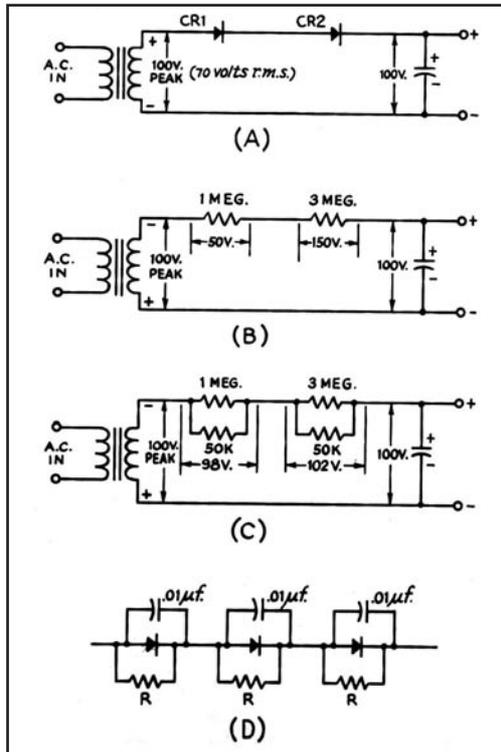
plus leurs voisines dans leur chute en cas de dépassement de la tension crête inverse maximum supportable. Auparavant, une diode qui "claquait" se mettait en court-circuit, augmentant ainsi la tension présente aux bornes de chacune des autres diodes et le phénomène se propageait ainsi de bout en bout pour aboutir à la destruction de toutes les diodes de l'alimentation. Ce n'est plus le cas maintenant.
