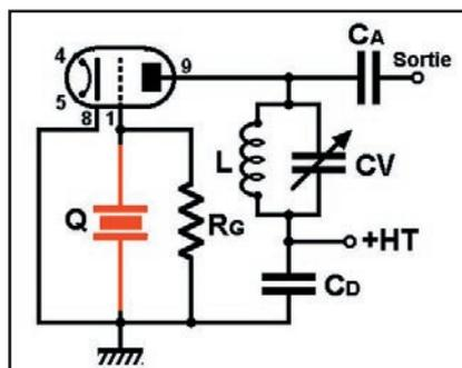
Figure 6: Notre oscillateur à quartz et triode.
