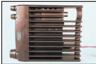
3 - Un dissipateur occupe toute la surface de l'appareil.
