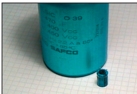
Photo 2 : Deux condensateurs de 470 µF.
