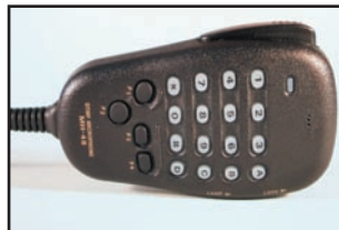
4 - Le micro à clavier DTMF est fourni d'origine.
