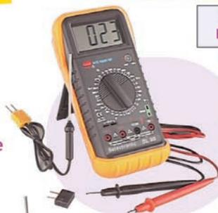
\* 32 calibres \* Transistormètre, thermomètre, fréquencesmètre et capacimètre \* Polarité automatique \* Affichage géant LCD 2000pts (25 mm) avec indication du calibre de mesure \* Test de diodes et de continuité par buzzer \* Dim. : 189 x 91 x 31,5 mm.
