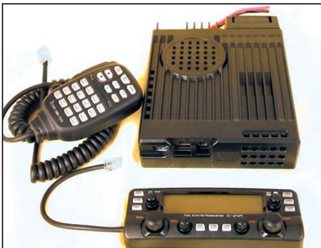
Photo 2 : Les 3 parties qui composent l'IC-2725E.
