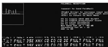
Fig. 8: Ecran du logiciel FELDHELL en réception.
