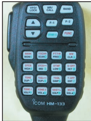
Photo 4: Le micro permet de contrôler la plupart des fonctions de l'appareil.
