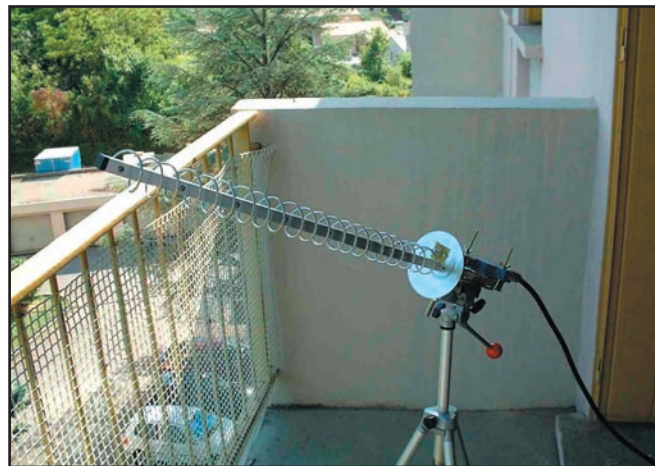
Figure 5: Antennes hélice avec convertisseur Drake pour réception AO-40.
