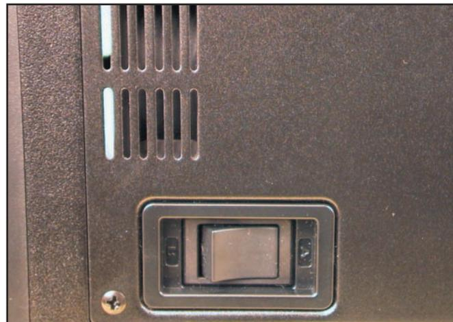
Le gros switch de commutation des batteries.
