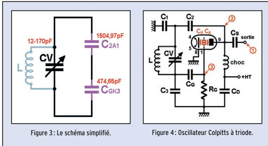
Figure 3: Le schéma simplifié.
