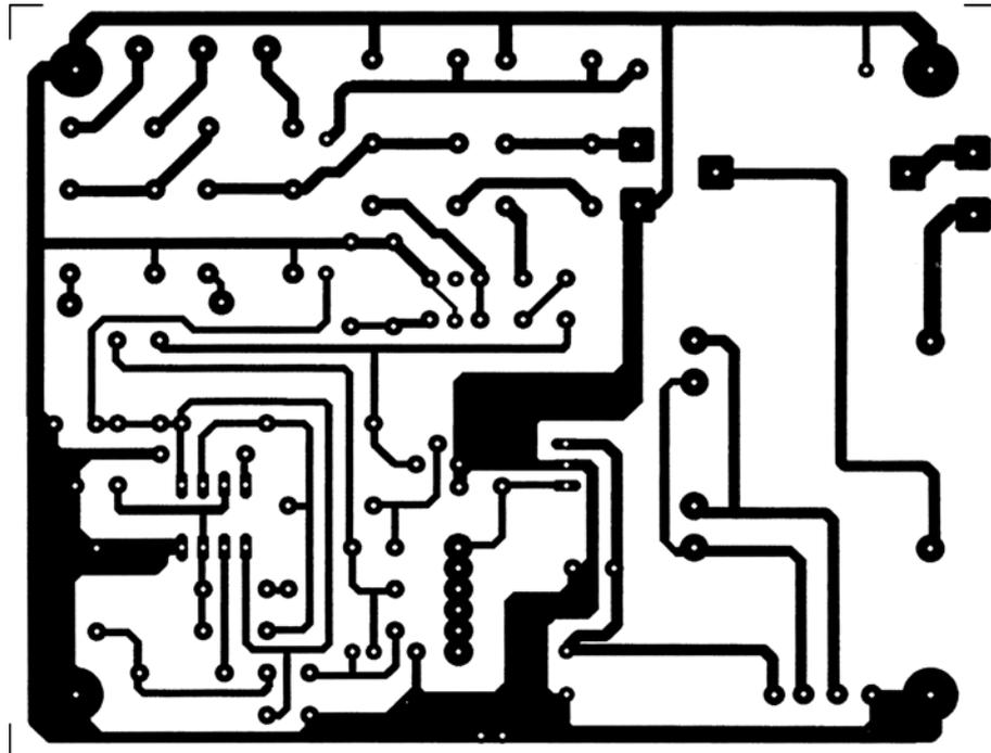
Figure 9: Le circuit imprimé à l'échelle 1:1.
