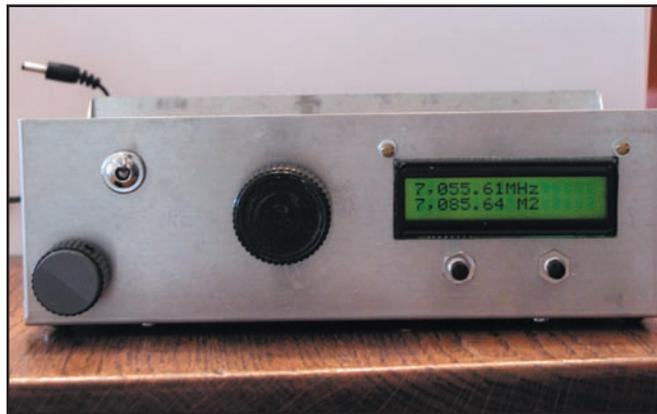
Le fréquencemètre dans le boîtier.
