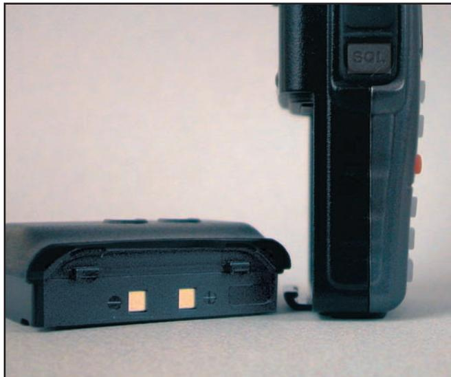
Profil de l'IC-E90: la batterie Li-Ion de 7,4 V est peu encombrante.
