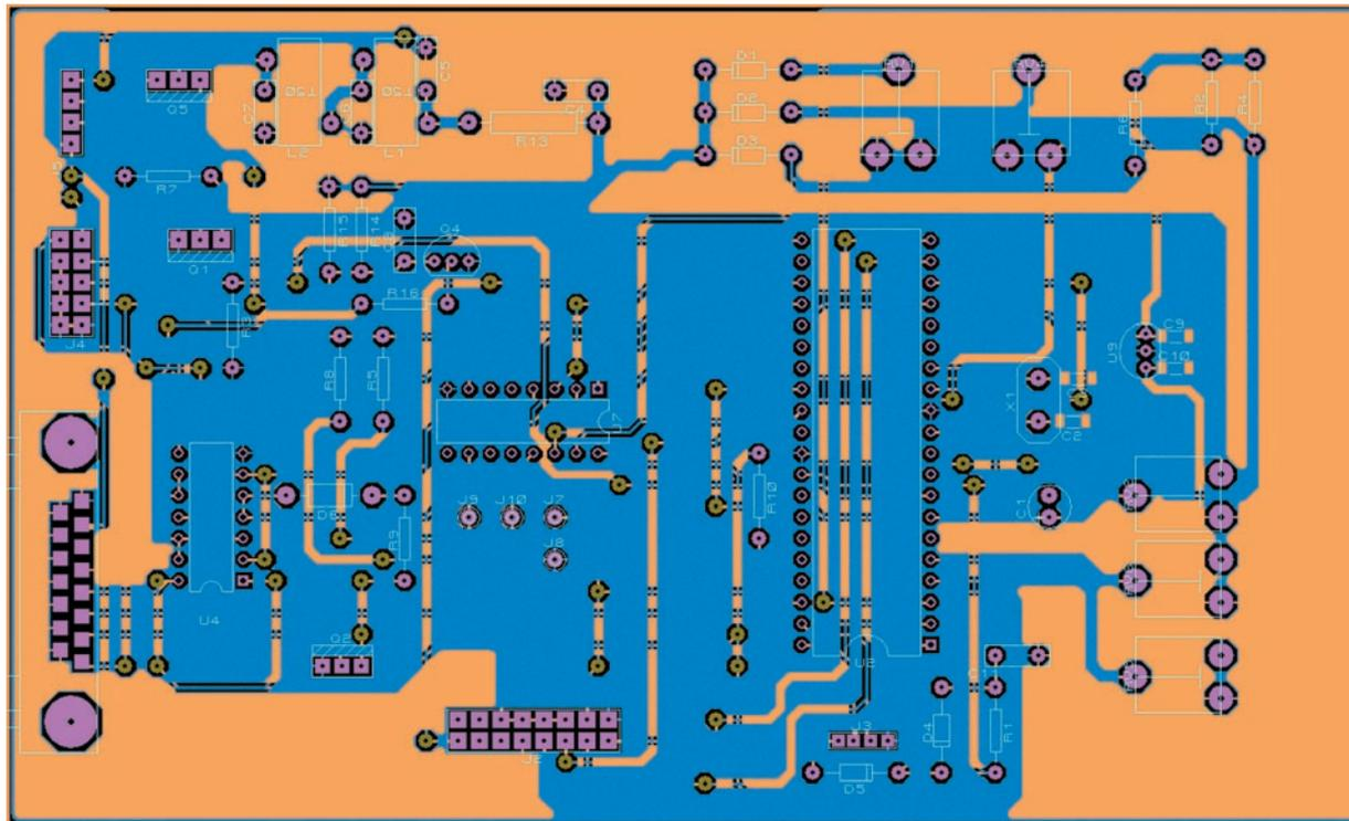
Figure 2bis: Platine contrôle/gestion : 100 x 160 mm - Implantation.
