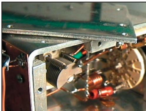
Figure 3: "Un boîtier robuste pour un oscillateur stable".
