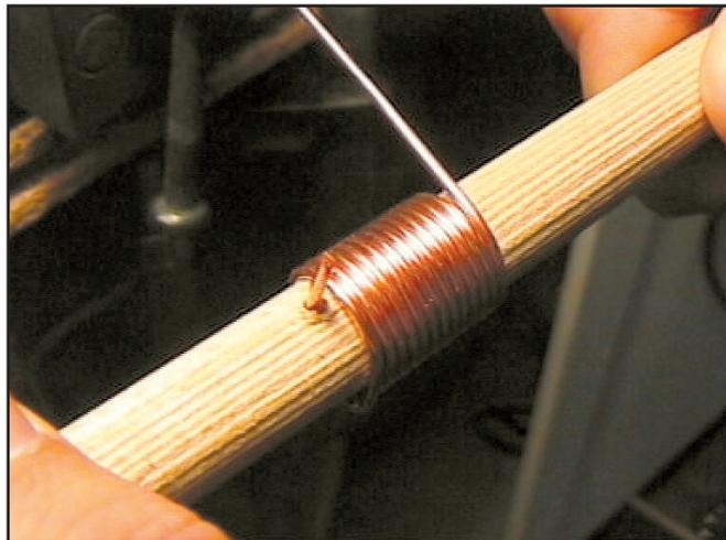
Figure 6: "Bobinage sur un mandrin en bois".
