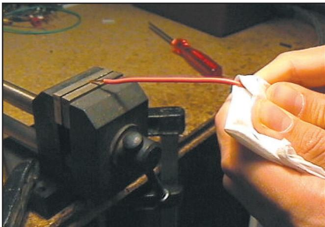
Figure 5: "Pour redresser un fil de cuivre tordu".
