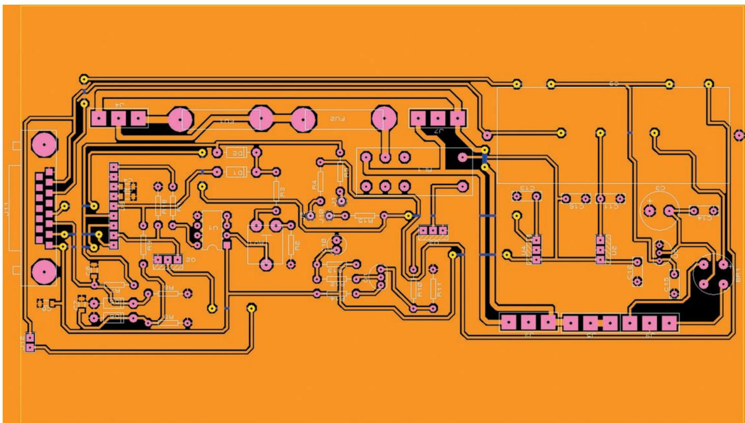
Figure 5 bis : Platine alimentation auxiliaire : 110 x 186 mm - Implantation.
