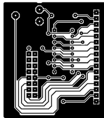
Figure 4 : Platine LCD : 42 x 49 mm - Circuit imprimé.
