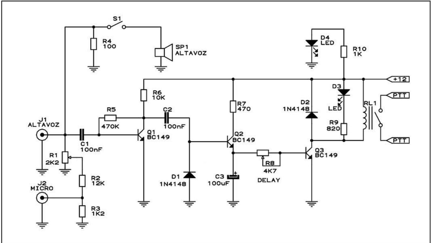
Figure 1: Schéma électrique.
