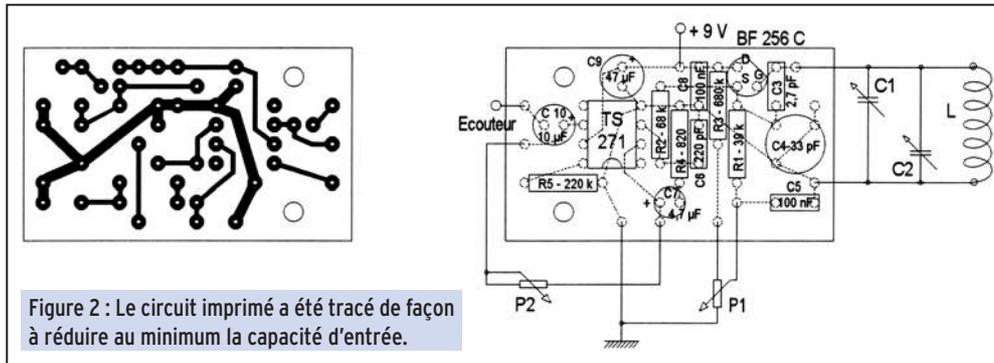
Figure 2 : Le circuit imprimé a été tracé de façon à réduire au minimum la capacité d'entrée.
