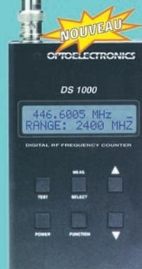
**DS-1000 - Fréquencemètre digital et analogique 10 MHz à 2,6 GHz.** Permet la capture des fréquences selon les protocoles APCO 25, Tetrapol, TDMA, GSM, On/Off Keying et fréquences pulsées (500 µs mini). Fonction mesureur de champ (-45 à -5 dBm). Sortie C15 permettant d'accorder automatiquement un récepteur compatible sur la fréquence capturée (uniquement analogique). 1000 mémoires pouvant être chargées dans un PC via la sortie RS-232.
