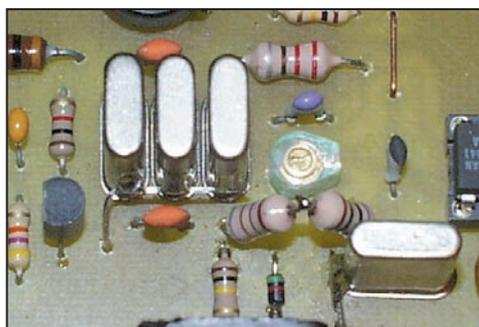
PA, lors d'un oubli de branchement de l'antenne par exemple. La sortie vers l'antenne se fait au travers du filtre passe-bas C1-L1-C2. Celui-ci n'est qu'à une seule cellule, vu que les étages précédents ne sont pas à large bande, mais très sélectifs. La puissance HF disponible en sortie est de plus de 2 watts effectifs.
