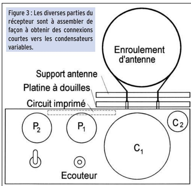
Figure 3 : Les diverses parties du récepteur sont à assembler de façon à obtenir des connexions courtes vers les condensateurs variables.
