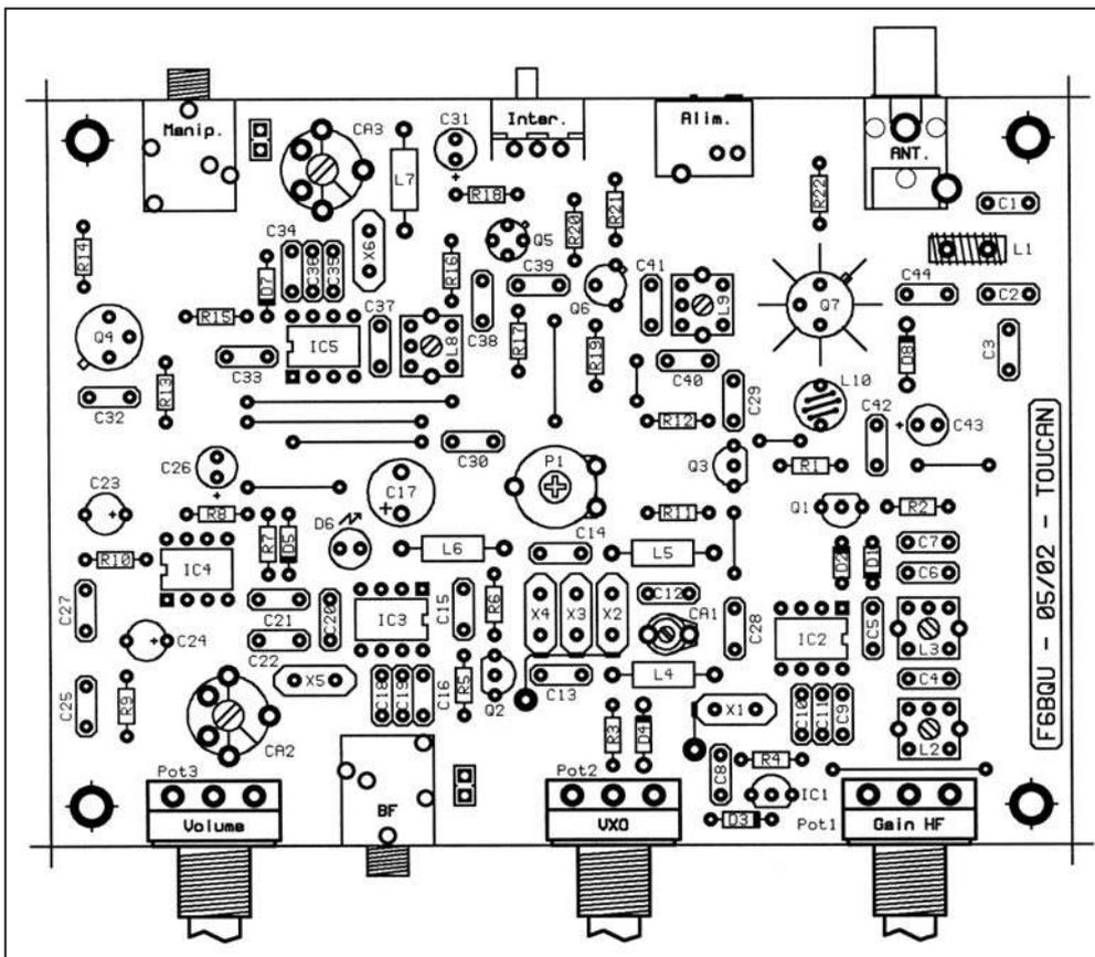
5 de IC5, et passant par un premier filtre de bande (L8-C37), est amplifiée, en classe A, par Q5 et Q6. Un deuxième filtre de bande (L9-C41) permet une meilleure réjection des harmoniques indésirables. Q7 est l'amplificateur final. Il fonctionne en classe C, ce qui permet de le laisser alimenté en permanence (soulageant ainsi Q4 en courant). La diode zener D8 protège l'étage final contre une surtension destructrice du transistor du
