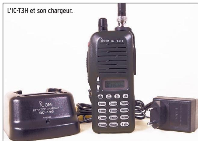
ture du squelch et permet également d'en régler le seuil à l'aide des deux touches en forme de flèche. Ces deux touches ont également pour rôle de sélectionner les canaux (et le niveau audio si on modifie le paramétrage). Le clavier DTMF classique est surmonté par 4 touches A, B, C, D permettant d'apprendre l'alphabet. Non, peut-être que leur rôle est différent, j'ai dû mal lire ! Ces 4 touches sont affectées aux fonctions suivantes :
