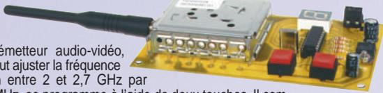
Ce petit émetteur audio-vidéo, dont on peut ajuster la fréquence d'émission entre 2 et 2,7 GHz par pas de 1 MHz, se programme à l'aide de deux touches. Il comporte un afficheur à 7 segments fournissant l'indication de la fréquence sélectionnée. Il utilise un module HF à faible prix dont les prestations sont remarquables.
