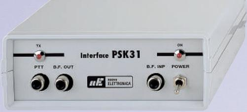
Si vous possédez un ordinateur doté d'une carte audio au standard Sond Blaster, ainsi qu'un émetteur-récepteur décimétrique, pour émettre et recevoir en PSK31 / SSTV / FAX / CW / RTTY, vous n'aurez besoin de rien d'autre que de cette interface et son logiciel.
