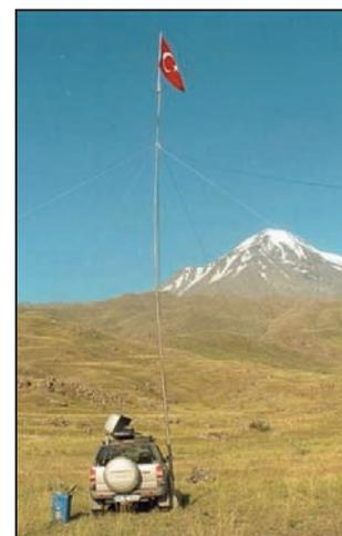
pique militaire de 12 mètres, à utiliser avec des antennes long fil accordées principalement par deux "Smart tuners". Un ordinateur portable était prévu aussi.
