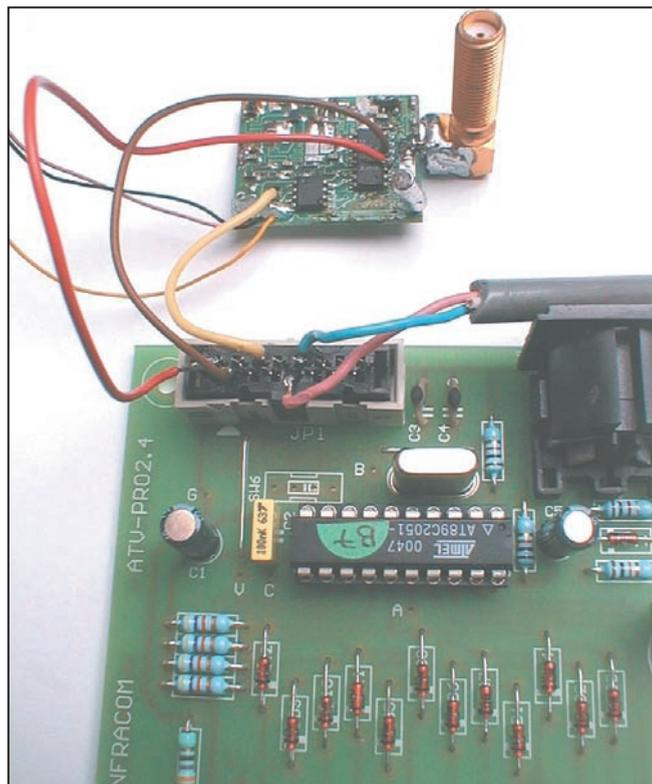
Intéressons nous maintenant à la platine ATVPRO 2.4. Pour commencer, retenir que cette dernière s'alimente en 5 V et non pas en 12 V comme le MiniTX24. Il faudra soit prévoir une alimentation séparée, soit prévoir une régulation 5 V. Reliez la demi-lune TX sur le côté soudures, de façon à valider le fonctionnement en tant qu'émetteur.
