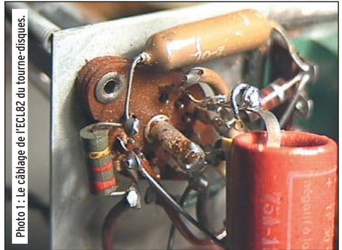
Photo 1 : Le câblage de l'ECL82 du tourne-disques.
