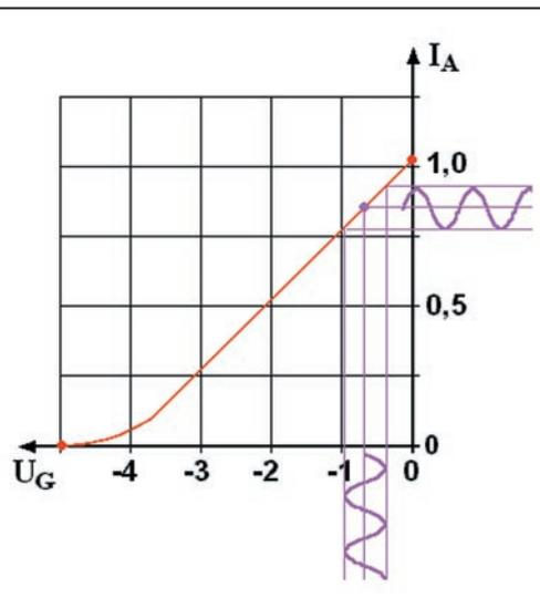
Figure 6 : Courant d'anode en fonction de tension grille.
