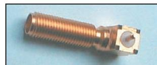
droit précis où était soudée l'âme du câble coaxial précédemment dessoudé, tout en ayant au préalable plaqué le corps de l'embase même contre le boîtier métallique de l'émetteur. Quelques coups de pince coupante viendront à bout de l'excédent. Déposez une toute petite goutte de soudure sur la pinoche, positionnez l'embase sur le circuit de l'émetteur, chauffez de nouveau : l'embase doit tenir d'elle-même si la soudure est correcte.
