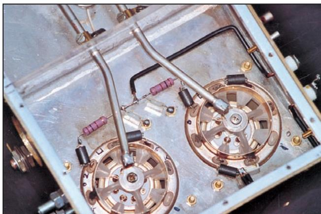
ligne L3 qui est réalisée en tôle cuivre ou laiton pour des raisons pratiques de soudures. L3 est constituée en trois parties : la ligne par elle-même, les deux parties du stator du condensateur C4, et les deux clips fixations des anodes des tubes. Il est souhaitable que toutes ces parties soit argentées. Les photos 3 et 4 nous détaillent la vue de dessous de l'amplificateur, côté lignes grilles.
