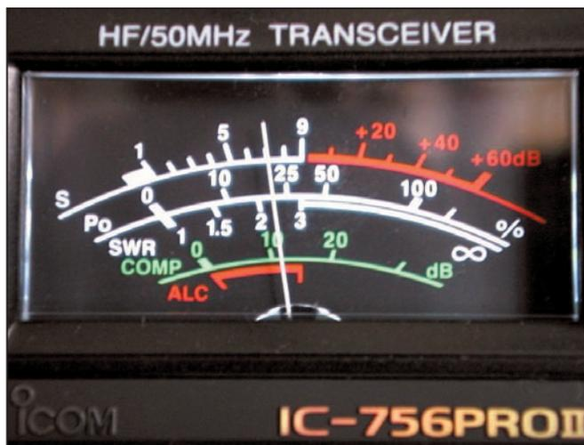
Un Smètre calibré à 3 dB par point.
