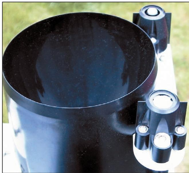
Le pluviomètre et les capteurs solaires.
