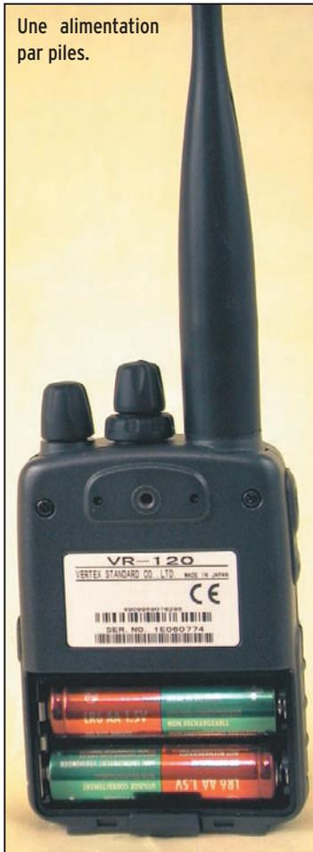
souhaite. C'est heureux car, avec les changements d'attribution de fréquences, on a parfois des surprises : ainsi, sur la partie supérieure de la bande VHF aviation (au-dessus de 136 MHz, le mode auto passe en FM, seul le mode manuel permet de sélectionner l'AM). Le pas, également préprogrammé peut aussi être modifié.
