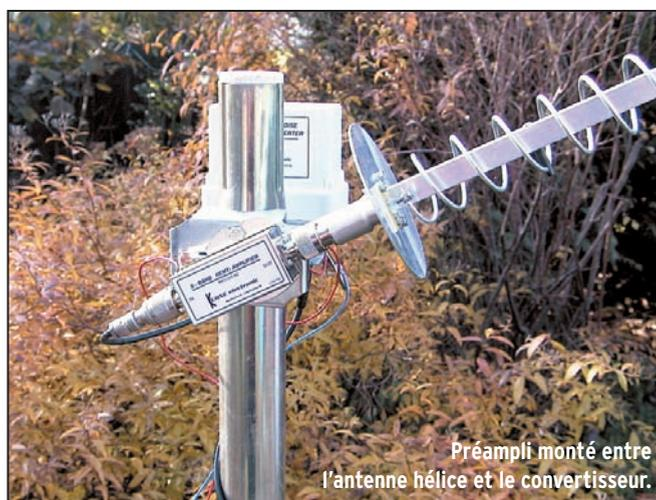
Préampli monté entre l'antenne hélice et le convertisseur.
