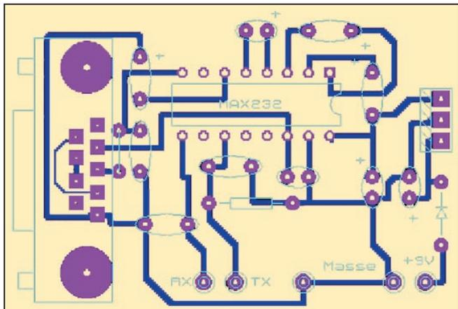
Dans l'autre sens, (PC vers TX) la logique TTL plus généreuse en courant fait facilement basculer l'entrée de la prise CAT et il n'y a besoin de rien pour que cela fonctionne.
