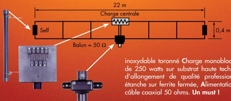
inoxydable toronné Charge monobloc non selfique de 250 watts sur substrat haute technologie, Selfs d'allongement de qualité professionnelle, Balun étanche sur ferrite fermée, Alimentation directe par câble coaxial 50 ohms. **Un must !**
