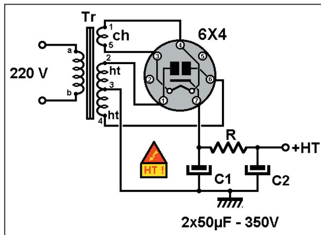
Figure 2 : Schéma de la partie alimentation.
