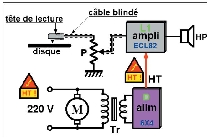
Figure 1 : La haute-tension dans le tourne-disque.
