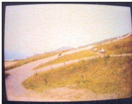
Photo 17-5 : Avec démodulateur et F = 1,5 dB, avec "DNR".
