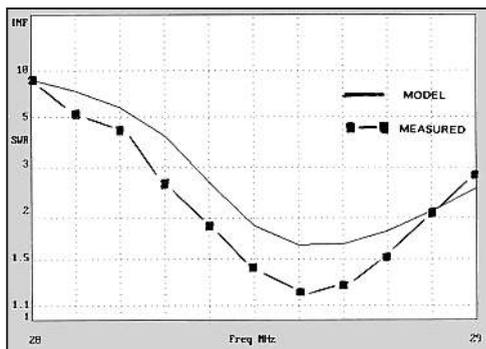
Elle mesure 1,5 x 1,5 mètres sans perte d'efficacité par rapport à la version non fractalisée. Elle n'a pas besoin de circuit d'adaptation et son impédance est de 50 ohms. On peut donc l'alimenter directement avec le câble coaxial. Avec cette
