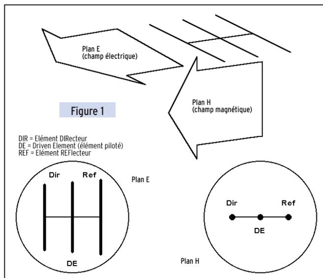
Hormis le couplage entre éléments et autres objets tous proches de l'antenne, le champ magnétique sera beaucoup moins important que le champ électrique. Dans ce cas, le champ électrique E est prépondérant et permet des liaisons radio de grande distance, mais le champ magnétique H, aussi faible soit-il, n'est pas supprimé et reste associé au champ électrique E.
