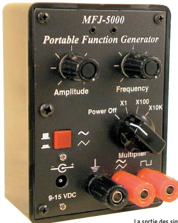
La sortie des signaux s'effectue sur des douilles "bananes".
