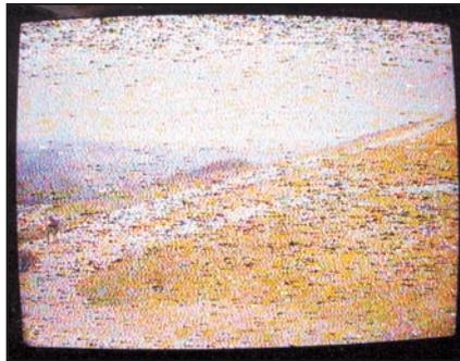
Photo 17-2 : + 6 dB après. Réception avec démodulateur satellite.
