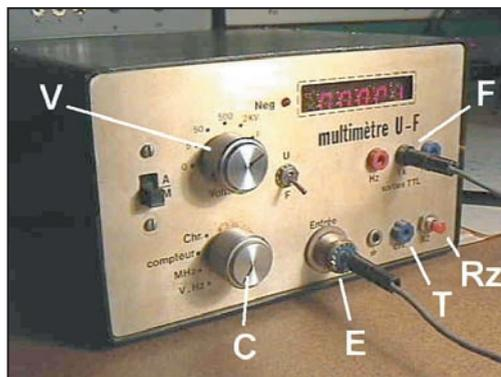
Figure 1 : La face avant du fréquencemètre.
