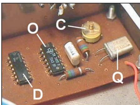
Figure 3 : L'oscillateur de la base de temps.
