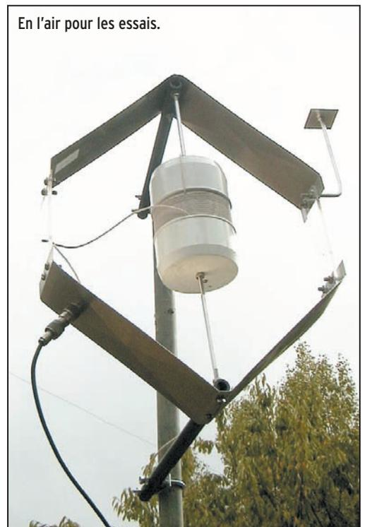
l'ensemble est reliée aux plaques par des tiges filetées. On ajustera leur longueur en les vissant plus ou moins dans la self. Côté haut, le fil de la
