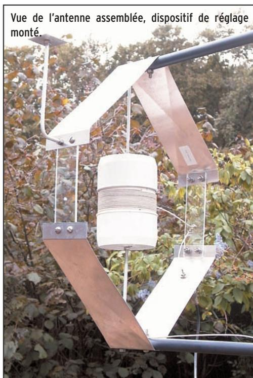
site un tournevis et une clé de 12. Les deux éléments du condensateur se montent sur deux plaques de Plexiglass. La bobine, placée au centre de
