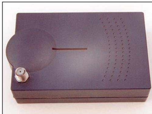
Photo 15 : TX monocanal avec adaptation "F".
