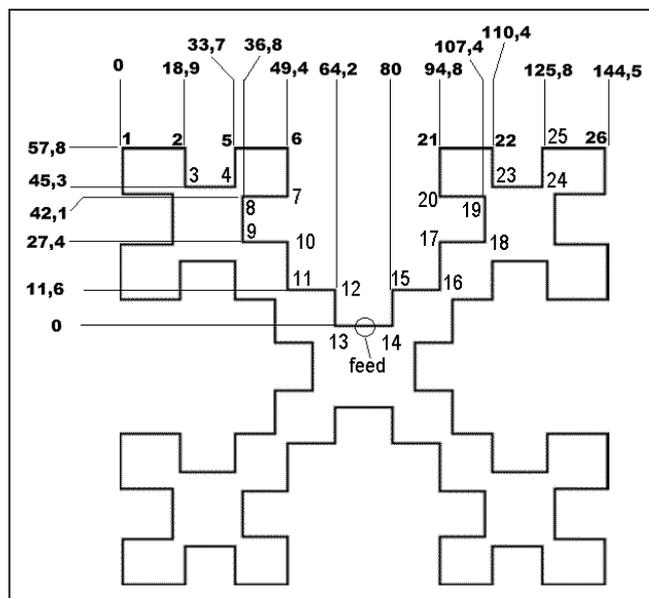
Figure 13 : Dimensions en centimètres des boucles fractalisées.
