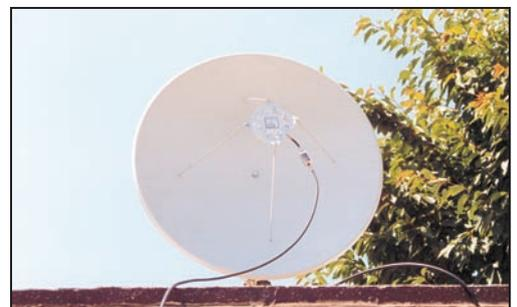
Photo 12 : LNBY monté au foyer d'une parabole. On remarque l'ampli de ligne BIS.
