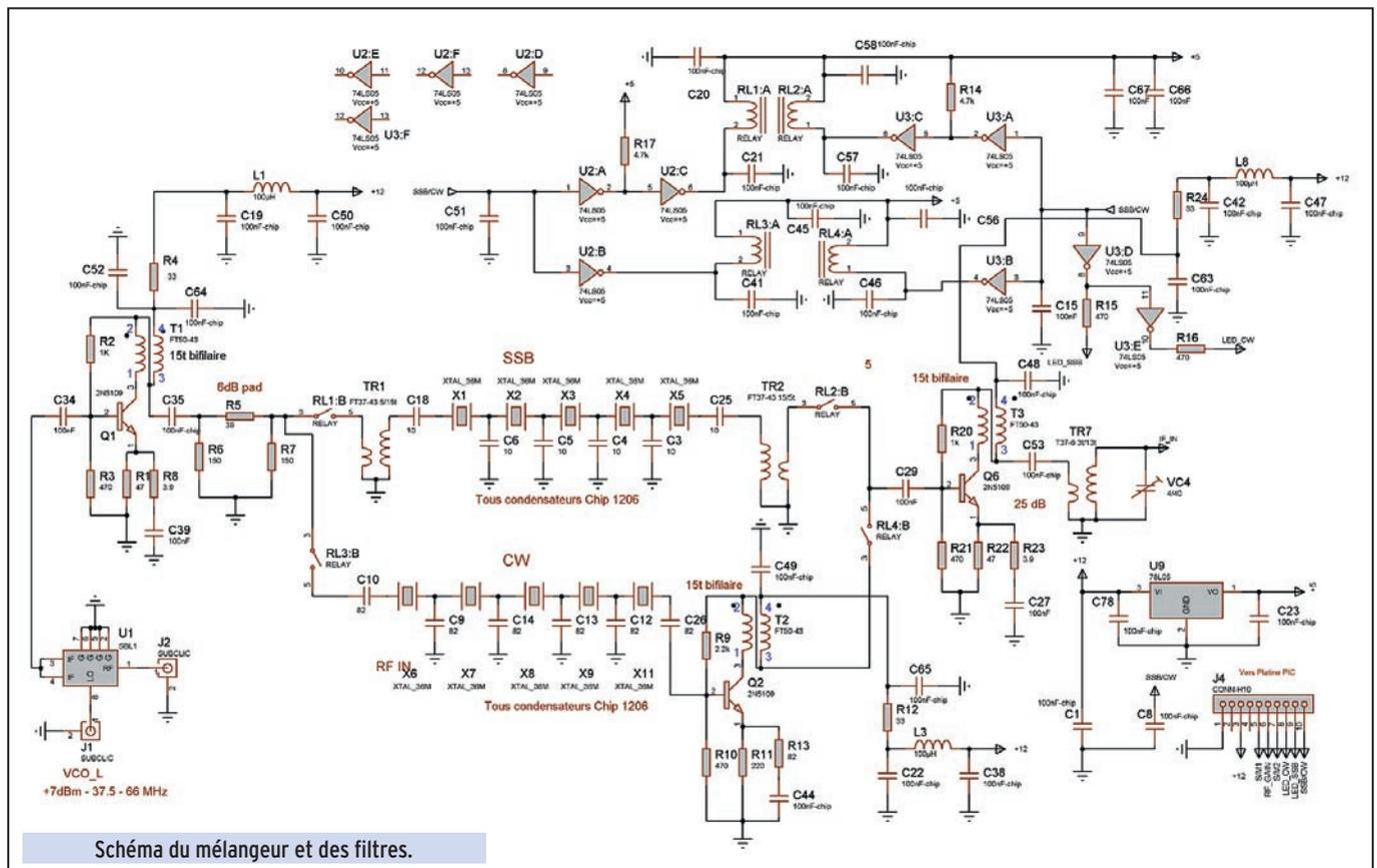
Schéma du mélangeur et des filtres.
