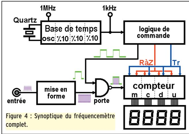
Figure 4 : Synoptique du fréquencemètre complet.
