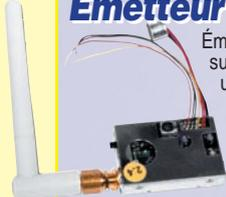
Émetteur vidéo miniature avec entrée microphone travaillant sur la bande des 2,4 GHz. Il est livré sans son antenne et un microphone électret. Les fréquences de transmissions sont au nombre de 4 (2.413 / 2.432 / 2.451 / 2.470 GHz) et sont sélectionnables à l'aide d'un commutateur. Caractéristiques techniques : Consommation : 140 mA. Alimentation : 12 V. Dim. : 40 x 30 x 7,5. Puissance de sortie : 10 mW. Poids : 17 grammes.
