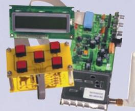
Fonctionnant dans la bande s'étendant de 2 à 2,7 GHz, il trouvera également une utilité non négligeable dans la recherche de mini-émetteurs télé opérant dans la même gamme de fréquences.
